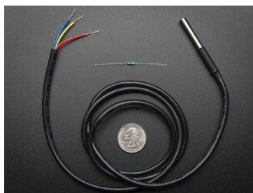
Εικόνα 35. Water Proof DS18B20 Digital temperature sensor
