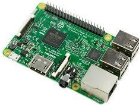
Εικόνα 26. Raspberry Pi 3 Model B
