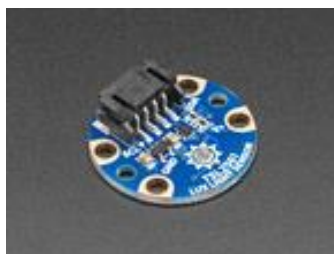
Εικόνα 40. TSL2561 Αισθητήρας Φωτεινότητας
