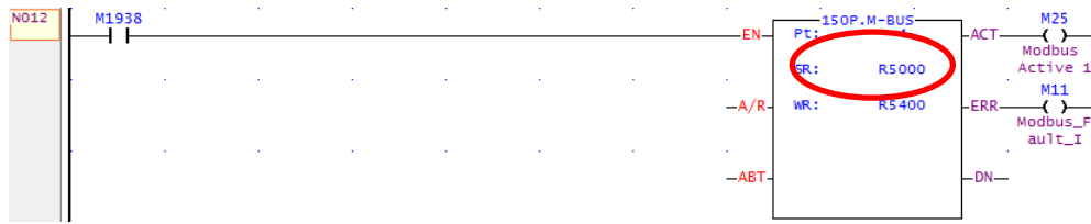
Εικόνα 3.7: Εντολή FUN150 για επικοινωνία μέσω Modbus.
