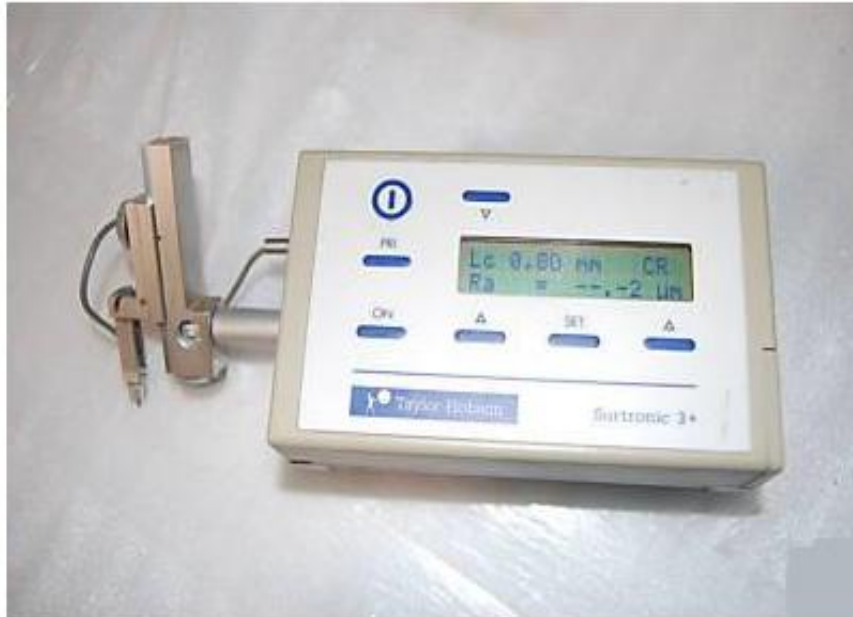
Σχήμα 2.3. Μηχανικό φορητό τραχύμετρο Taylor - Hobson Surtronic 3+ (Α.Ε.Ι. ΠΕΙΡΑΙΑ Τ.Τ.)
