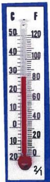
Εικόνα 7.9 Θερμόμετρο διαστολής υγρού
