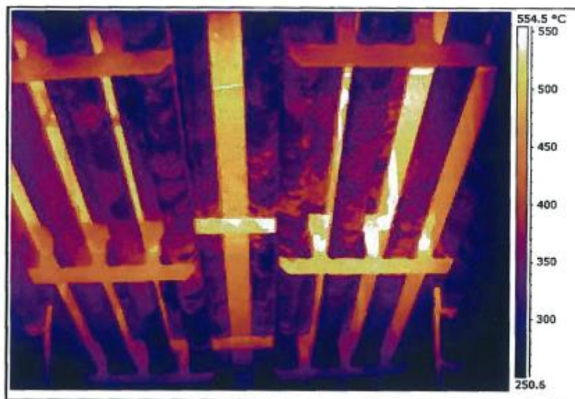
Εικόνα 3.6 Θερμογραφία σωλήνων φούρνου
