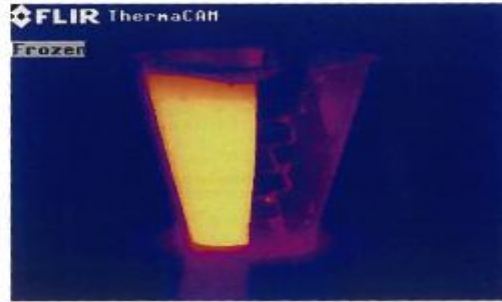
Εικόνα 5.20 Διαφορά εκπομπής ενός ισοθερμικού σώματος. Πίστωση εικόνας : Mikael Cronholm - ITC
