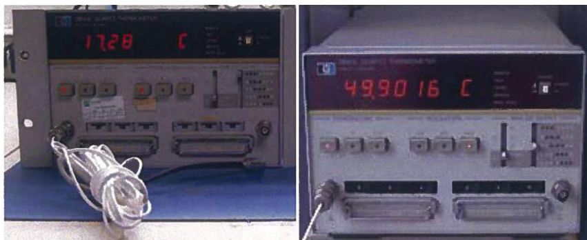
Εικόνα 7.17 Θερμόμετρα κρυστάλλων χαλαζία
