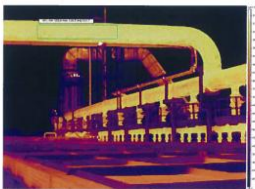
Εικόνα 5.28 Θερμογραφία ενός σωλήνα διυλιστηρίου. Πίστωση εικόνας ITC
