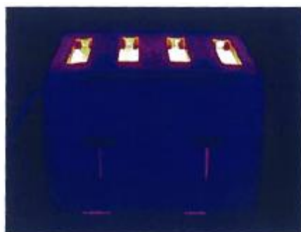
Εικόνα 5.26 Θερμογραφία μιας τοστιέρας. Πίστωση εικόνας : FLIR Training Centre
