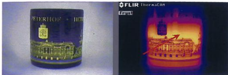
Εικόνα 5.21 Οπτική και θερμική εικόνα ενός ισοθερμικού αντικειμένου. Πίστωση εικόνας: Mikael Cronholm - ITC
