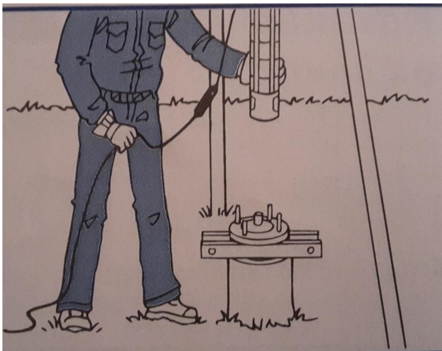
Σχήμα 10.6 : Κατακόρυφη εγκατάσταση της αντλίας.
