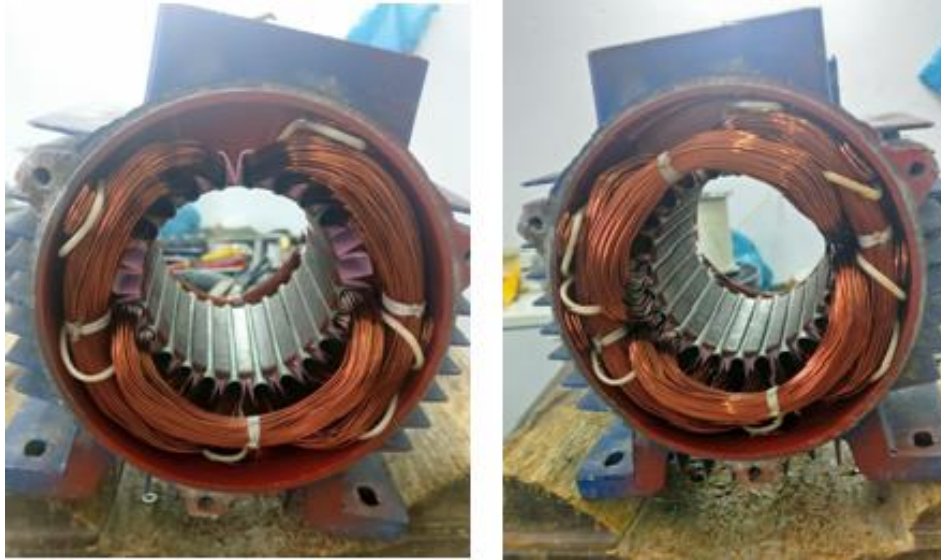
Εικόνα 7.16. Η τοποθέτηση του βοηθητικού τυλίγματος.
