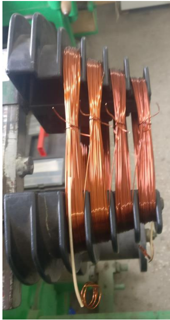
Εικόνα 7.10. Κύριο τύλιγμα του μονοφασικού κινητήρα.
