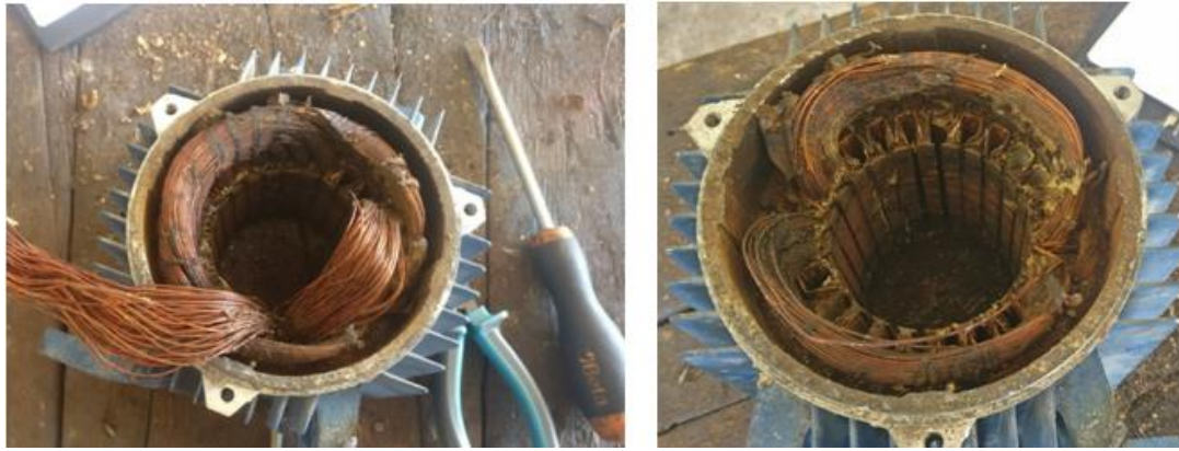
Εικόνα 7.4. Το ξήλωμα των σπειρών του στάτη
