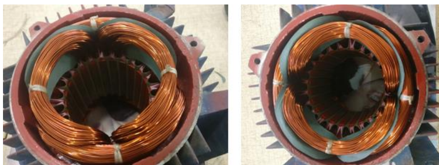
Εικόνα 7.19. Η τοποθέτηση των διαχωριστικών.
