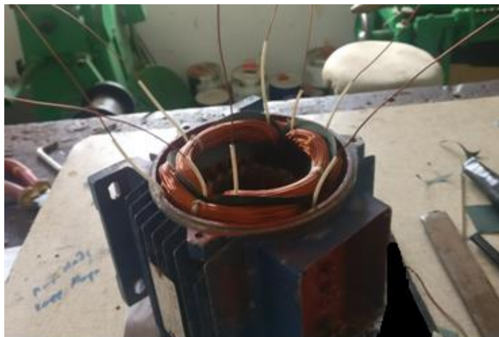
Εικόνα 7.21. Τα άκρα των ομάδων του κινητήρα.
