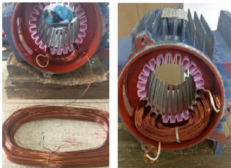
Εικόνα 7.14. Η τοποθέτηση της πρώτης ομάδας του κύριου τυλίγματος.
