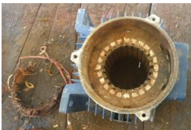
Εικόνα 7.3. Η πλευρά του στάτη με τα κομμένα τυλίγματα
