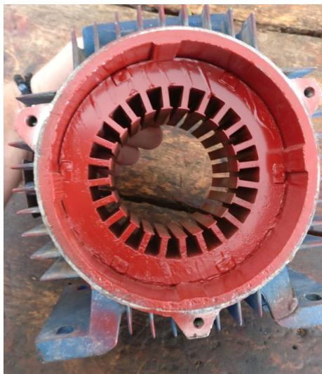
Εικόνα 7.5. Ο πυρήνας του κινητήρα καθαρισμένος από σύρματα και μονωτικά υλικά
