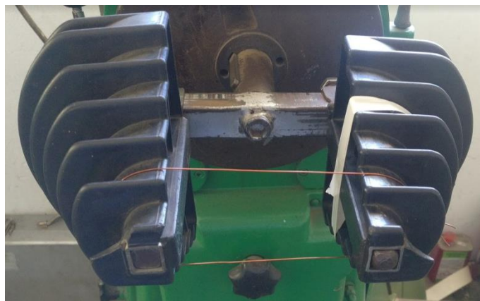
Εικόνα 7.9. Η απλή σπείρα σύρματος τοποθετημένη στα καλούπια περιέλιξης
