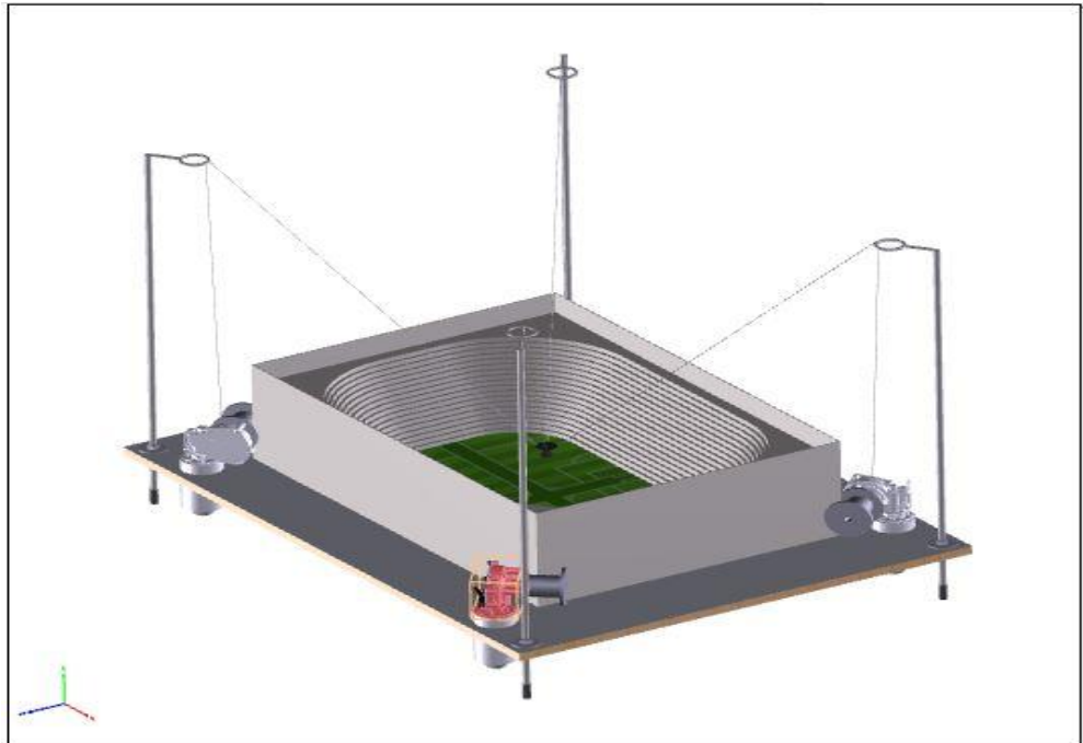
Εικόνα 4.16: 3D απεικόνιση του ρομποτικού συστήματος – Νο4
