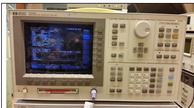
Σχήμα 3.1.6: α) Διάταξη ηλεκτρικού χαρακτηρισμού HP 4155A, β) η διάταξη των τριών μονάδων τροφοδοσίας/μέτρησης (Source Measure Unit) για την μέτρηση των χαρακτηριστικών ενός MOSFET.
