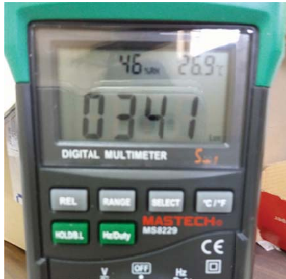
Σχήμα 4.3 Μέτρηση φωτισμού στον αντικρυστό τοίχο
