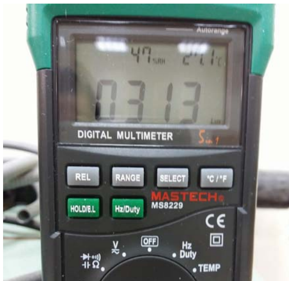
Σχήμα 4.2 Μέτρηση φωτισμού στον αντικρυστό τοίχο
