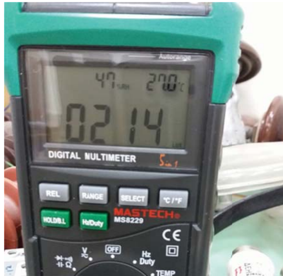
Σχήμα 4.1 Μέτρηση φωτισμού στον έναν τοίχο
