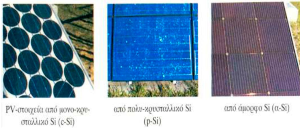
Σχήμα 2.8α Εμπρόσθια επιφάνεια τυπικών φωτοβολταϊκών στοιχείων Si ,τύπου : μονοκρυσταλλικό, πολυκρυσταλλικό ,λεπτού υμενίου (thinfilm) και thickfilm.
