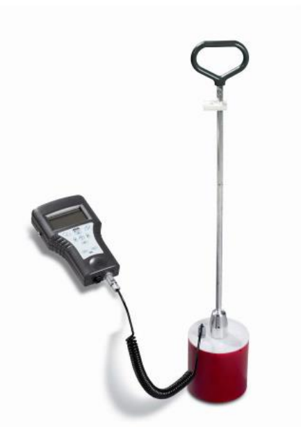
Σχήμα 4.17-Απεικόνιση του δέκτη ακουστικών συχνοτήτων UL 30 σε συνεργασία με το μικρόφωνο εδάφους BM 30 [29]
