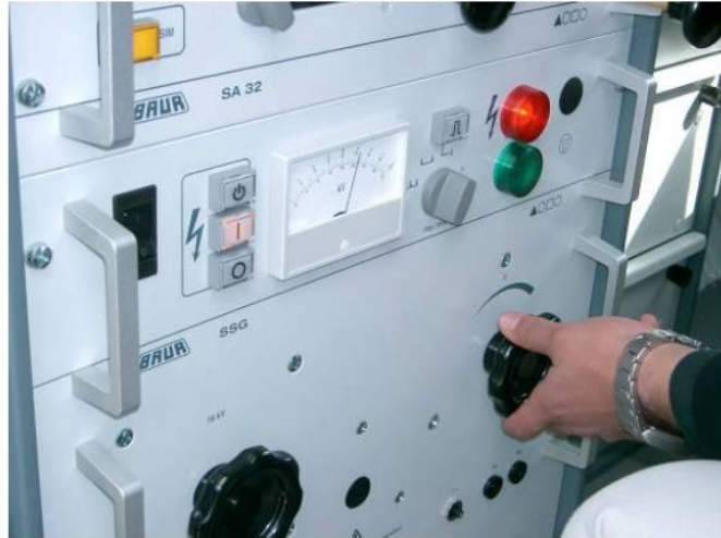
Σχήμα 4.5-Ρύθμιση της κλίμακας της τάσης σε γεννήτρια κρουστικών κυμάτων (SSG) της Baur[26]
