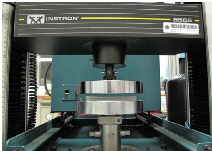
Εικόνα 2: Συσκευή συνθλίψεως για τη δοκιμασία των τριδιάστατων στημονολεκτών δοκιμών σε θλίψη [14].
