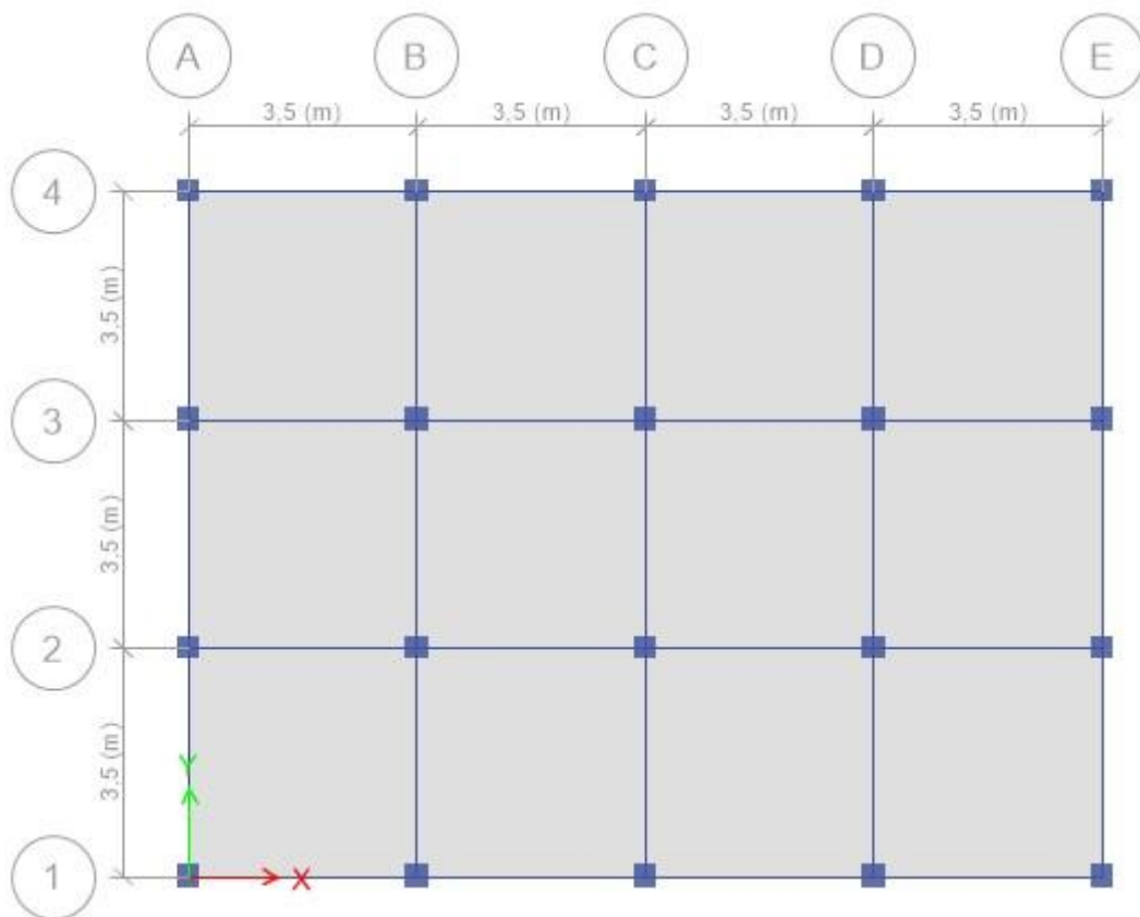
Σχήμα 3.7: Κάτοψη φορέα Ω.Σ. στο λογισμικό Etabs.
