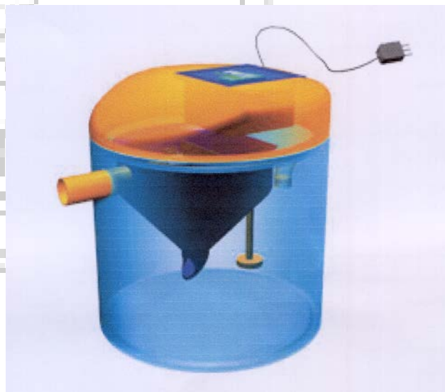
Εικόνα 4.1: Σύστημα βιολογικού καθαρισμού
