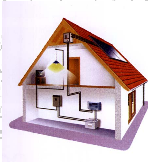
Εικόνα 4.7: Αυτόνομη ενεργειακά κατοικία με χρήση φωτοβολταϊκών στοιχείων (ΑΕΤ 2005)
