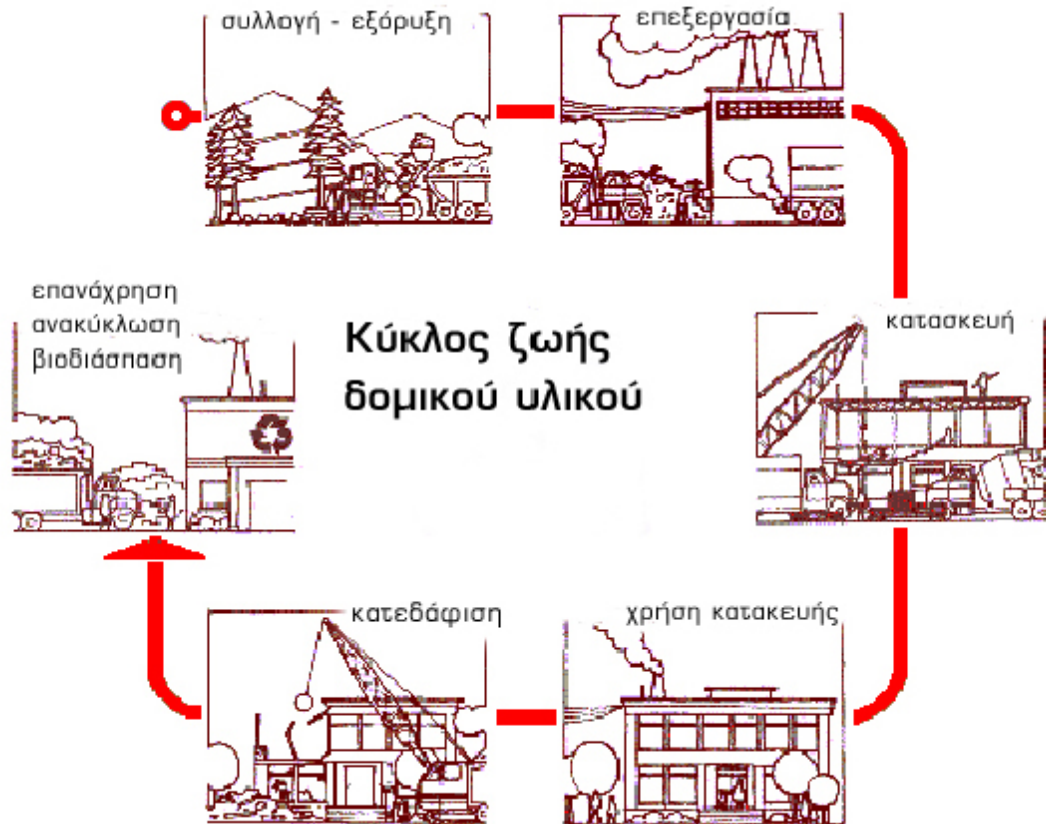
Εικόνα 1.1: Διάγραμμα ροής του κύκλου ζωής ενός δομικού υλικού (Κορωνάιος 2005)
