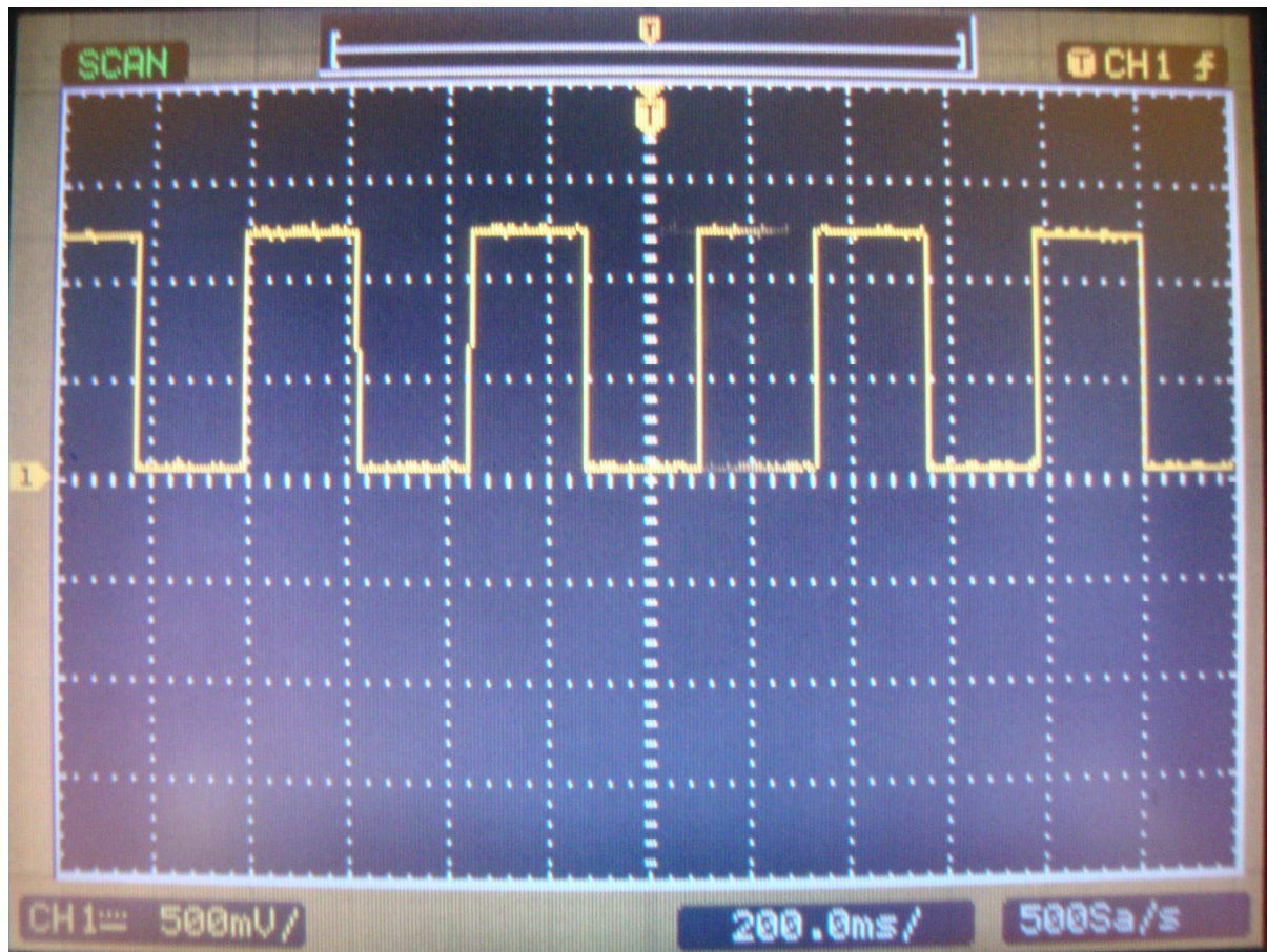
Εικόνα 4.3 Έξοδος των Οπτοcoupler
