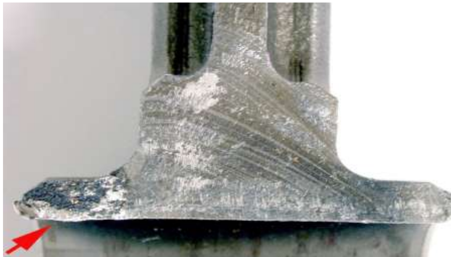
Εικ. 2.3 Παράδειγμα θραύσης σε δομικό στοιχείο
