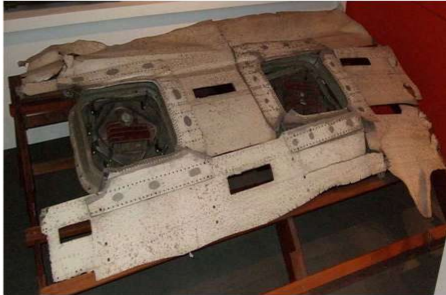
Εικ.1.5. Άτρακτος Comet Κομμάτι της ατράκτου του Comet, εκτίθεται στο Μουσείο Επιστημών του Λονδίνου, στο οποίο φαίνονται τα δύο παράθυρα στα οποία συνέβη η αρχική αστοχία.
