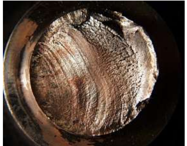
Εικ.2.5 Γραμμώσεις κόπωσης σε επιφάνεια θραύσης
