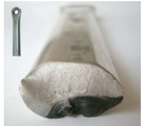
Εικ. 2.2 Παράδειγμα θραύσης σε άξονα
