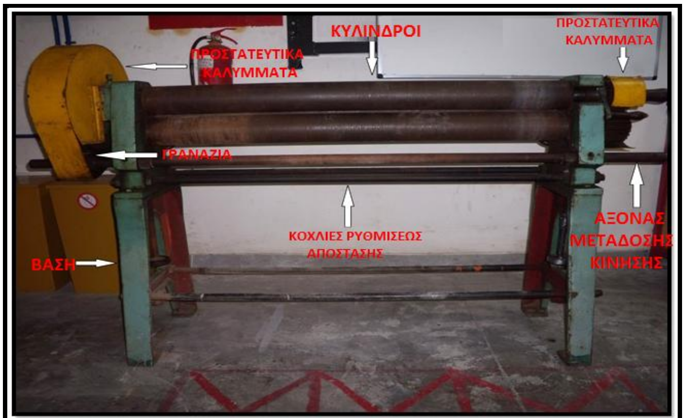
Εικόνα 4.5 Μέρη κυλίνδρου
