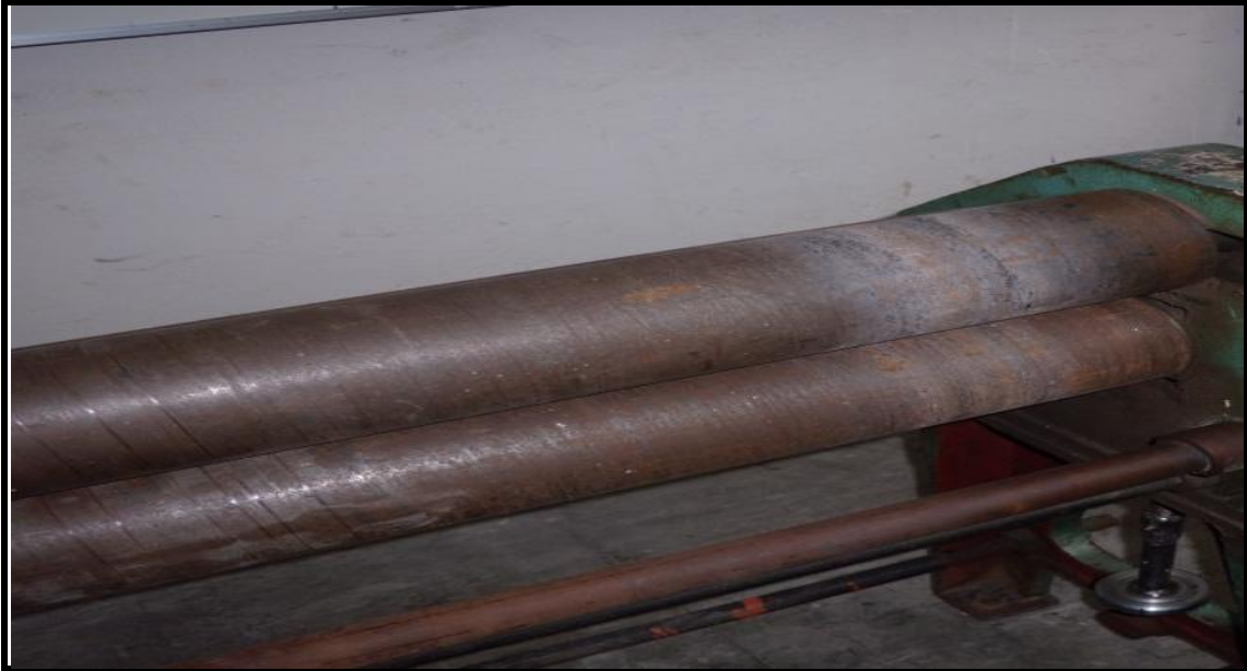
Εικόνα 4.10: Αρχική κατάσταση των αξόνων πριν τον καθαρισμό
