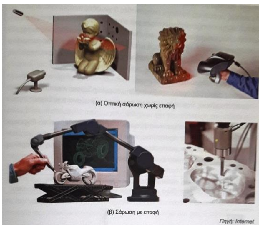
Σχήμα 1.7 : Η διαδικασία της ψηφιοποίησης, με οπτική σάρωση (α) και (β) με επαφή [2]
