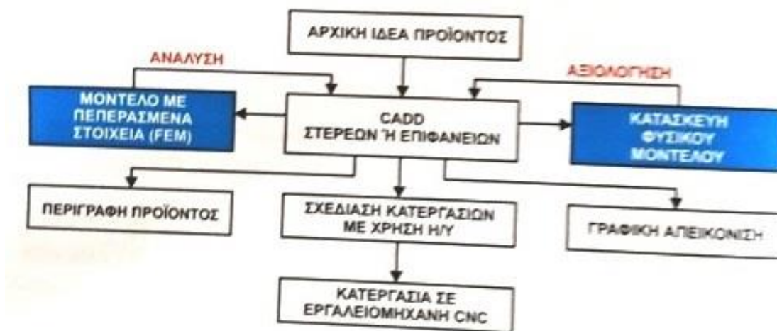
ΣΧΗΜΑ 1.3: Μέθοδος καταργασίας με χρήση συμβατικών μεθόδων και μεθόδων CAD[2]
