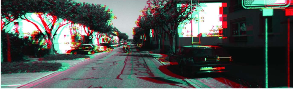
Εικόνα 2.1: Στερεοφωνικές εικόνες που έχουν επικαλυφθεί από την βιβλιοθήκη KITTI, παρατηρήστε ότι οι αντιστοιχίσεις σημείων παρακολούθησης είναι κατά μήκος παράλληλων (οριζόντιων) γραμμών. 9
