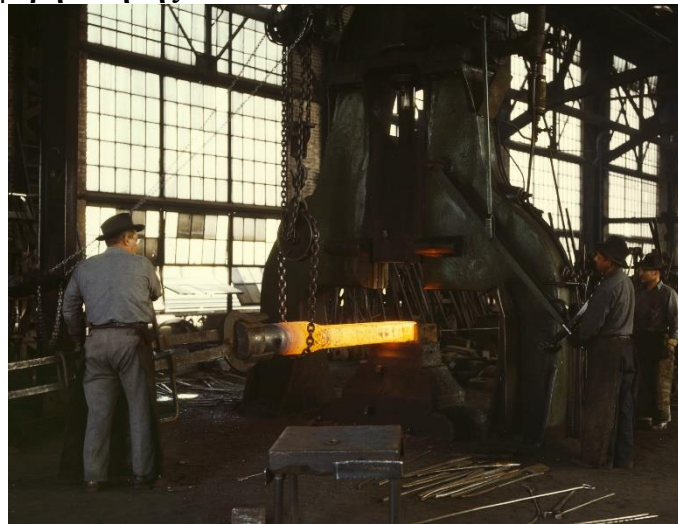
Εικόνα 6 Σφυρηλάτηση μιας ράβδου έλξης από την ατμοκίνητη πρέσα στο σιδηρουργείο του Santa Fe Railroad shops, Albuquerque, NM, 1943.
