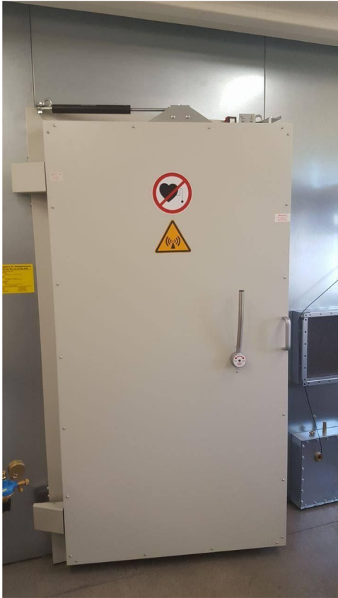
Εικόνα 4.2 Πόρτα ανηχοϊκού θαλάμου
