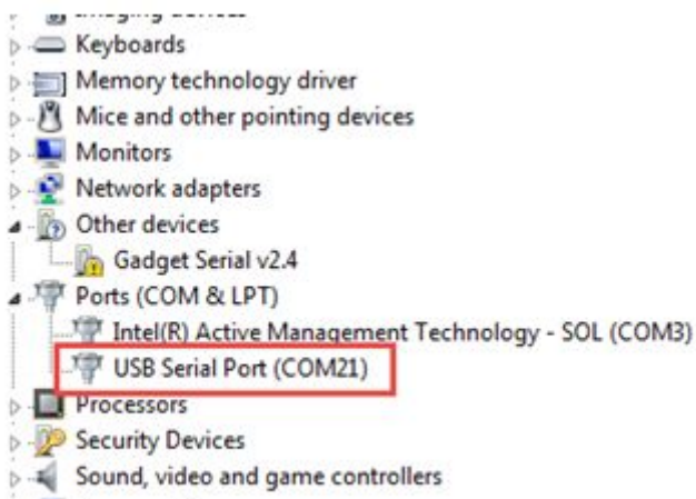
Εικόνα 3.3 Έλεγχος πόρτας σύνδεσης [15]
