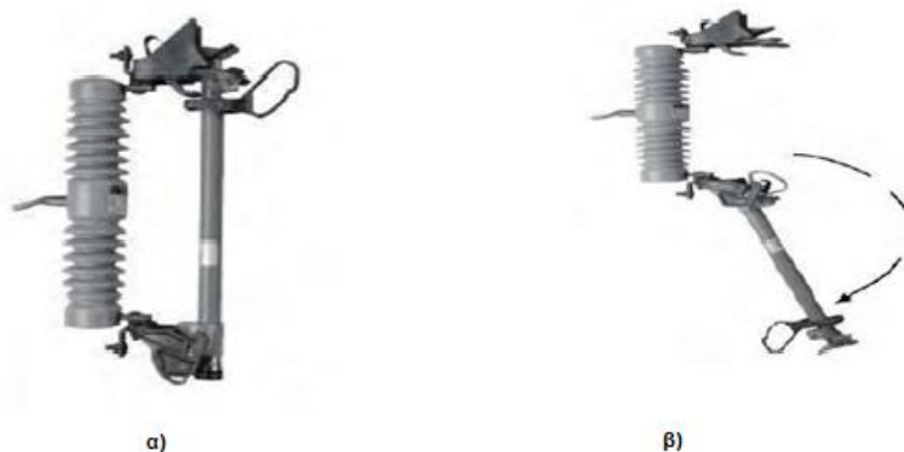
Σχήμα 2.10 - α) Ασφάλειας εκτόνωσης σε κατάσταση λειτουργίας, β) Ασφάλεια εκτόνωσης καμένη και αποσυνδεδεμένη από τη βάση
