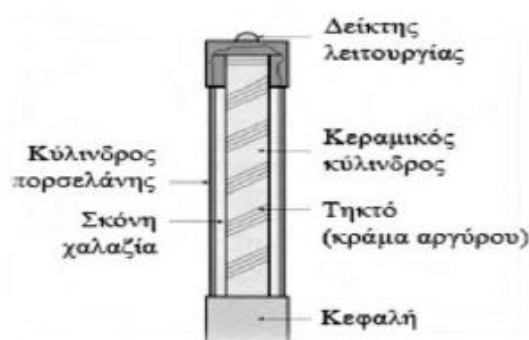
Σχήμα 2.9 - Βασικά μέρη ασφάλειας χαλαζία
