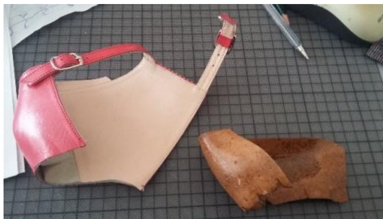
Εικόνα 6.12 Η φτέρνα και το θερμοσκληρυντικό της υλικό (πριν τοποθετηθεί)[21]
