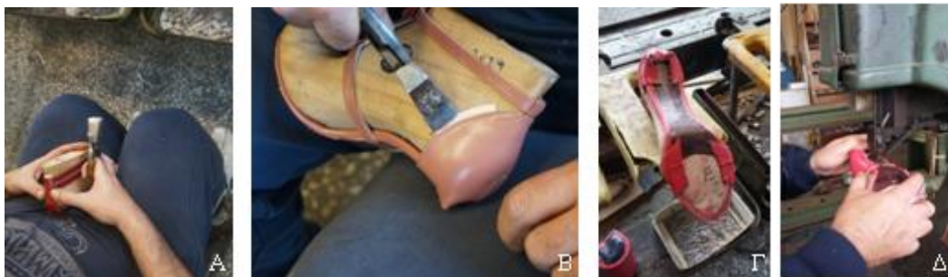
Εικόνα 6.20 Διαδικασία μονταρίσματος τοποθέτηση φτέρνας (Α), σωστή τοποθέτηση φτέρνας με χρήση της βοηθητικής φόδρας (Β), πρόχειρη κόλληση φτέρνας και κόλληση ψιδιού (Γ), τοποθέτηση τένκς στην καμάρα (Δ)[33]
