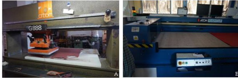
Εικόνα 4.12 Πρέσσα κοπής για φορτέτσα (Α), αυτόματο κοπτικό για φορτέτσα (Β) [29]
