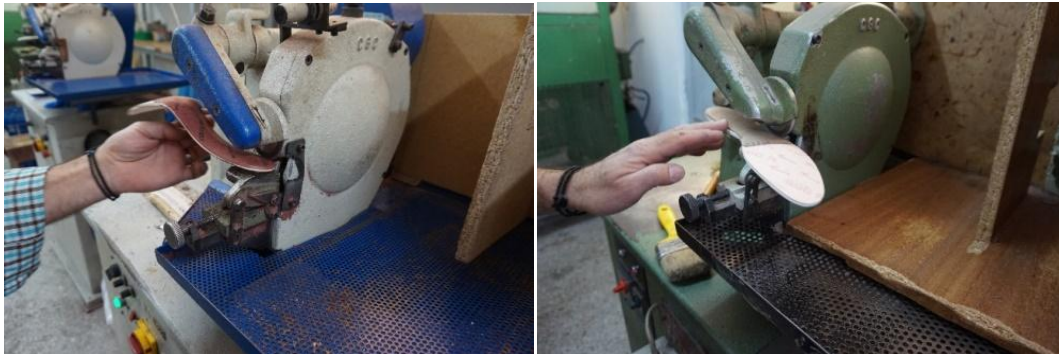
Εικόνα 4.21 Δημιουργία τελειώματος στην φορτέτσα [29]
