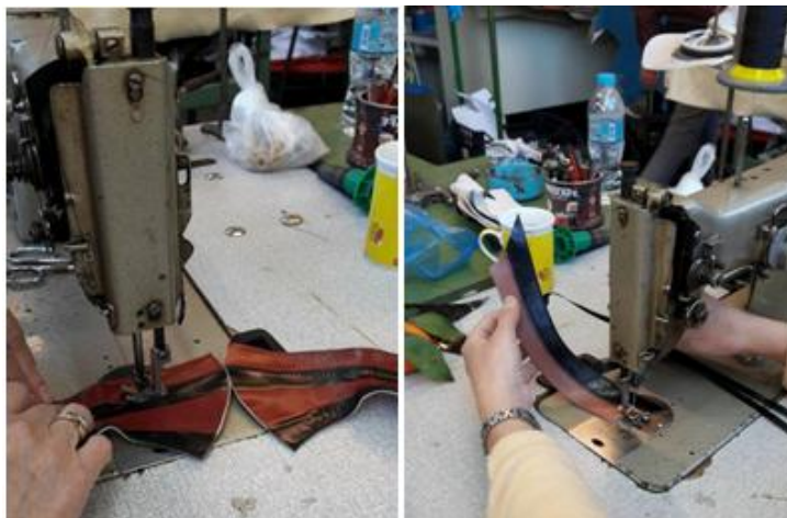
Εικόνα 6.10 Ραφή σε γαζωτική μηχανή ζικ-ζακ[33]
