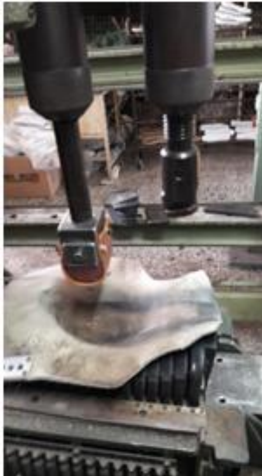
Εικόνα 6.25 Μηχάνημα που ασκεί πίεση για την σωστή συγκόλληση του πάτου με την σόλα[33]
