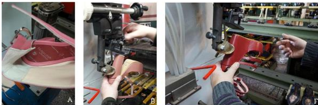
Εικόνα 6.27 Κάρφωμα τακουνιού (Α), τακουνάτου πέλματος (Β) και πέλματος (Γ)[33]
