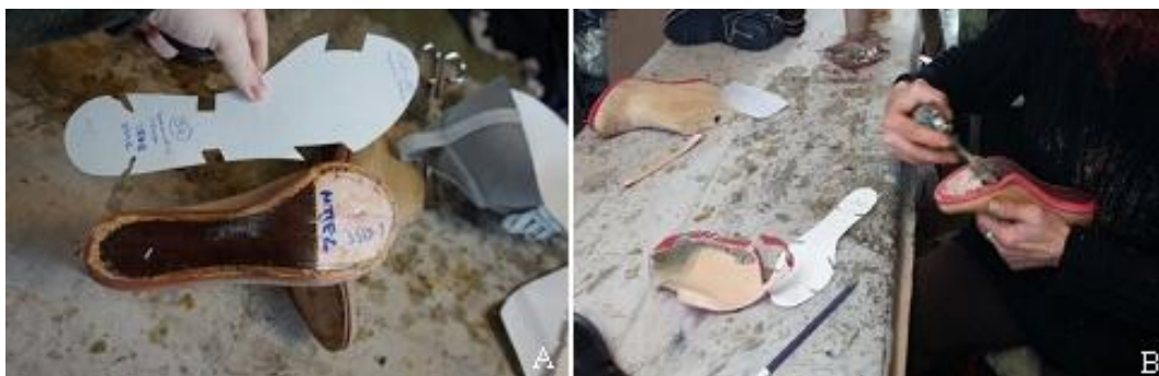
Εικόνα 6.18 Σημάδεμα πάτου με το σημαδευτήρι (Α), τοποθέτηση κόλλας (Β)[33]
