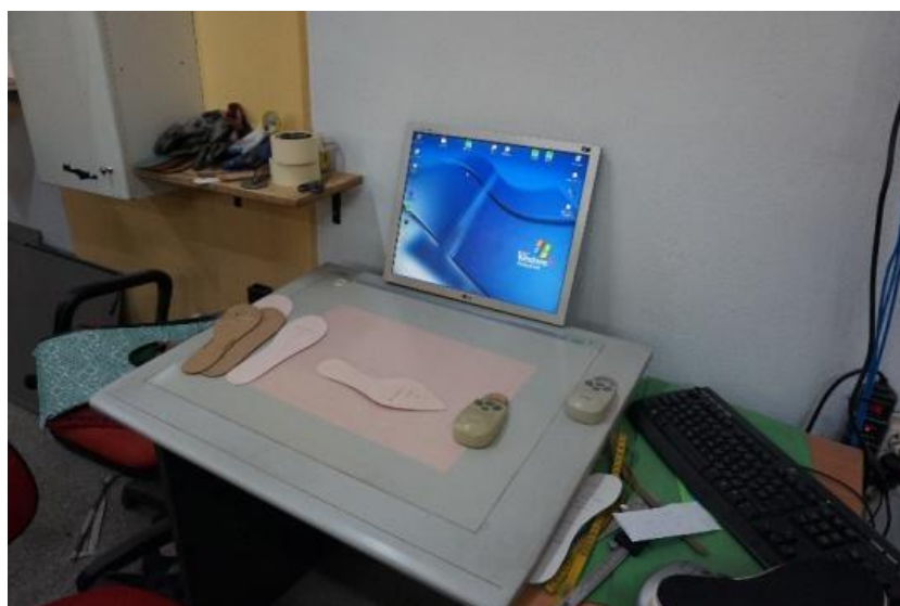
Εικόνα 4.9 Ψηφιοποίηση πρότυπου κοπής πάτου [29]
