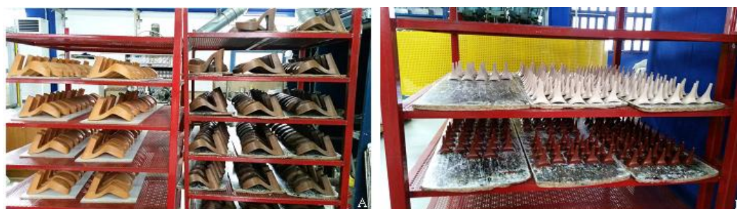
Εικόνα 4.24 Φινιρίσμα τακουνάτων πελμάτων (Α), τακουνιών (Β)
