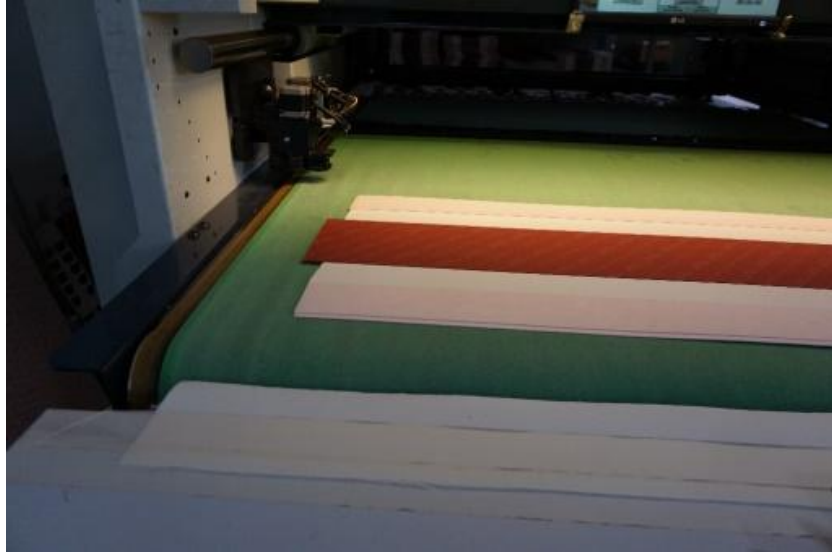
Εικόνα 4.11 Τραπέζι αυτόματης κοπής με ιμάντα [29]
