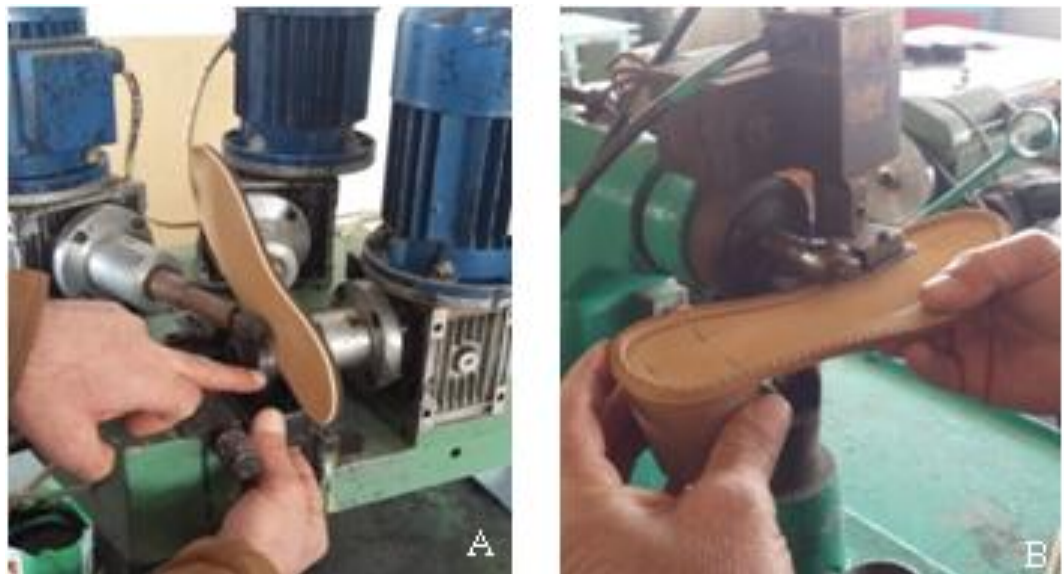
Εικόνα 4.28 βαφή τελειώματος σόλας (Α), τοποθέτηση βάρδουλου (Β)
