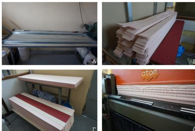
Εικόνα 4.10 Δημιουργία φύλλων κοπής πάτου, τραπέζι κοπής υλικών (Α), λωρίδες υλικού (Β), κόλληση υλικών (Γ), πίεση φύλλων υλικού σε πρέσα με φωτοκύταρο (Δ) [29]
