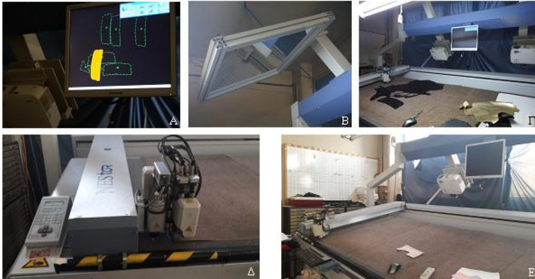
Εικόνα 6.5 Μηχάνημα αυτόματης κοπής (Ε) με χρήση υπολογιστή (Α), που προβάλλεται μέσω καθρέφτη (Β) από προτζέκτορα στο τραπέζι κοπής, η κοπή πραγματοποιείται μέσω της κεφαλής (Δ)[33]
