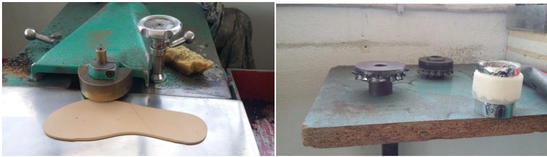
Εικόνα 4.26 Ρεφουλαριστική μηχανή για δημιουργία τελειώματος
