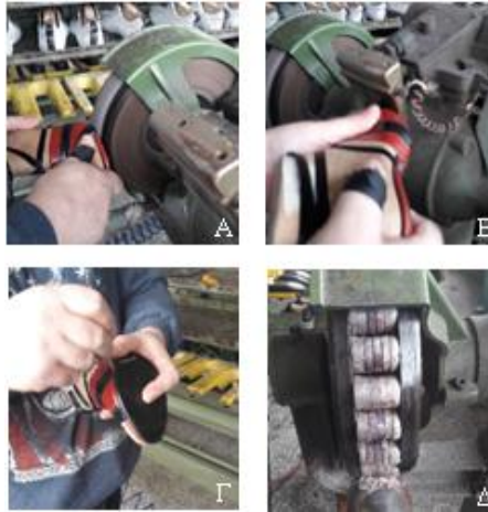
Εικόνα 6.23 Μηχάνημα λείανσης μετά το γυαλόχαρτο (γουρούνα) και σημάδεμα για την τοποθέτηση της σόλας(Γ) [33]
