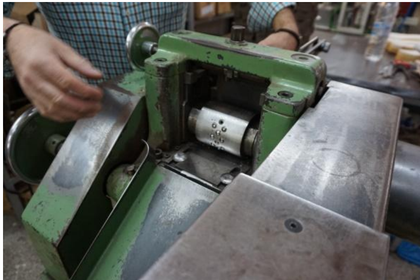
Εικόνα 4.13 Μηχανή λέπτυνσης υλικού, μήτρα[29]
