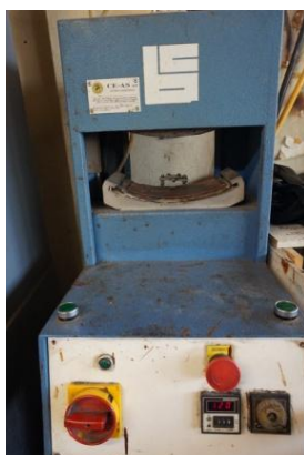
Εικόνα 6.14 Μηχανή σταθεροποίησης θερμοσκληρυντικού υλικού στην πόντα έτοιμη για χρήση[33]
