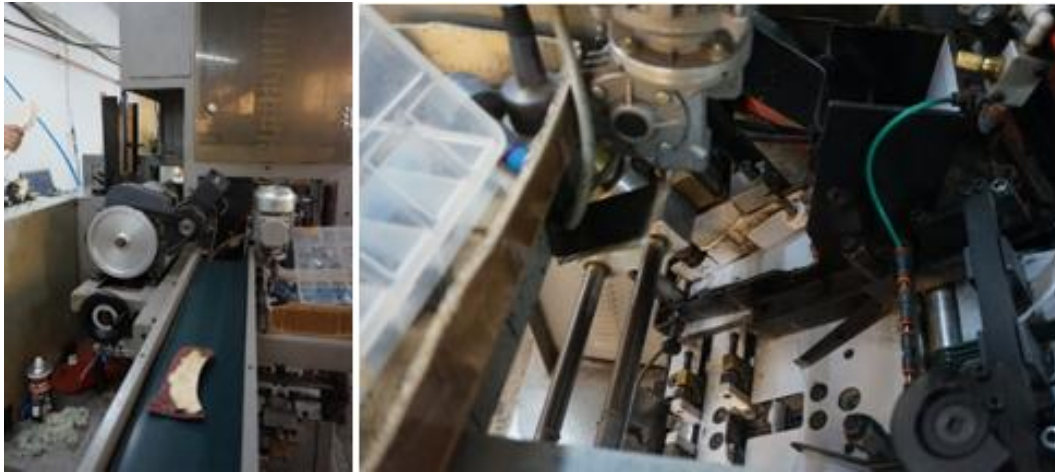
Εικόνα 4.17 Μηχάνημα τοποθέτησης φορτέτσας στον πάτο[29]
