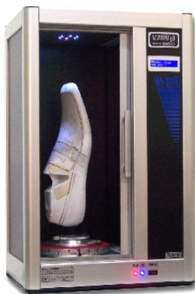
3.15 Τρισδιάστατη ψηφιοποίηση καλαποδιού (3D Scanny)[23]
