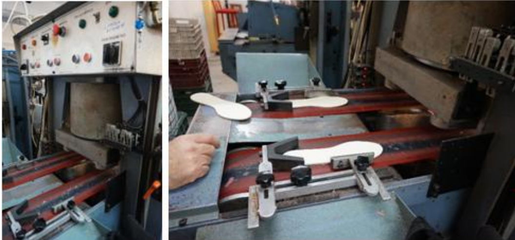
Εικόνα 4.19 Μηχάνημα που δημιουργεί την κλίση του πάτου για χαμηλά τακούνια[29]
