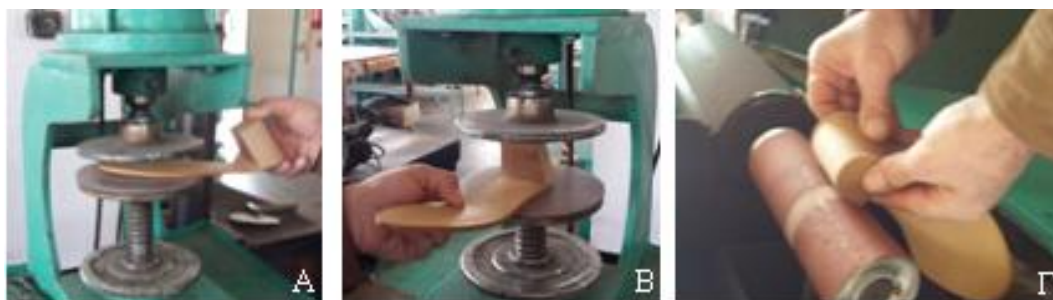
Εικόνα 4.30 Πρέσα για ισχυροποίηση συγκόλλησης (Α-Β), φινίρισμα με γυαλόχαρτο για πιο ομοιόμορφο αποτέλεσμα (Γ)
