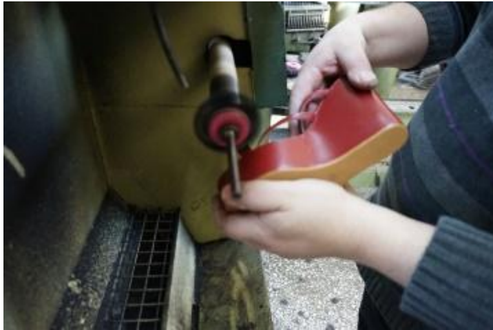
Εικόνα 6.28 Αφαίρεση υπολειμάτων κόλλας ( με βουρτσάκι)[33]
