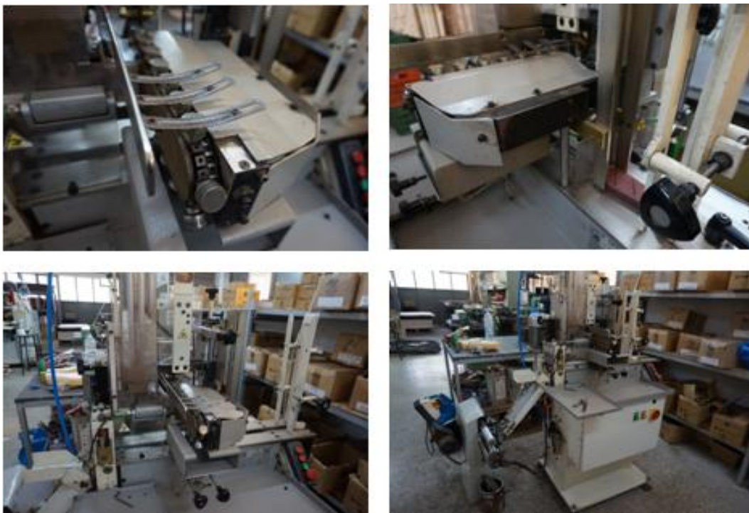
Εικόνα 4.14 Μηχανή τοποθέτησης μπανέλας και κόλλας στην φορτέτσα [29]
