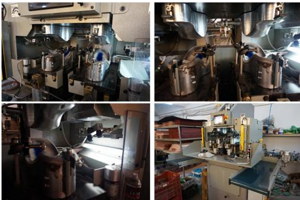
Εικόνα 4.20 Μηχάνημα που δημιουργεί την κλίση του πάτου για ψηλά τακούνια [29]
