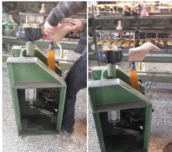
6.26 Αφαίρεση καλαποδιού σε ειδικό μηχάνημα[33]
