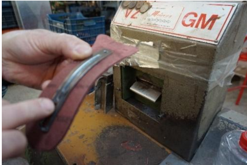
Εικόνα 4.15 Χειροκίνητη τοποθέτηση μπανέλας [29]
