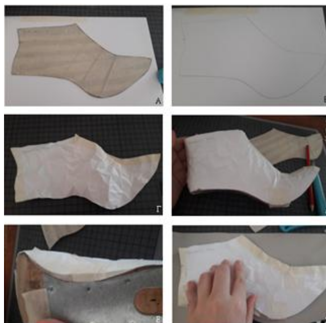
Εικόνα 3.6 Διαδικασία δημιουργίας πουκάμισου(Α-Γ), δοκιμή και διόρθωση πουκάμισου(Δ-Ε), δημιουργία τελικής βάσης καλαποδιού(Ζ)[21]
