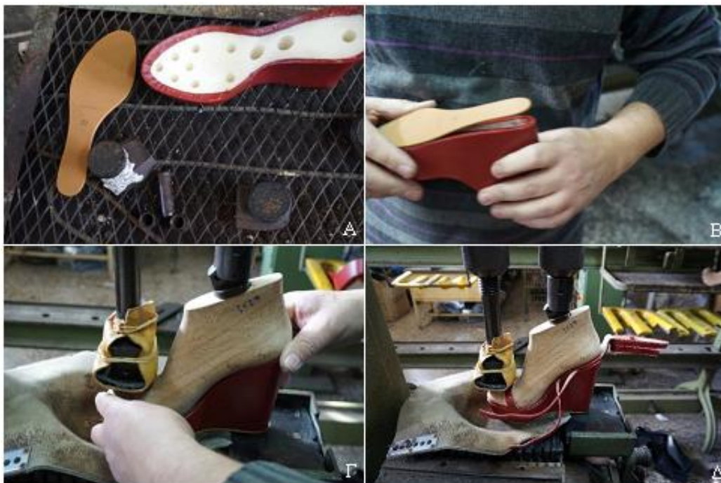
Εικόνα 6.24 Τοποθέτηση πέλματος και σόλας [33]
