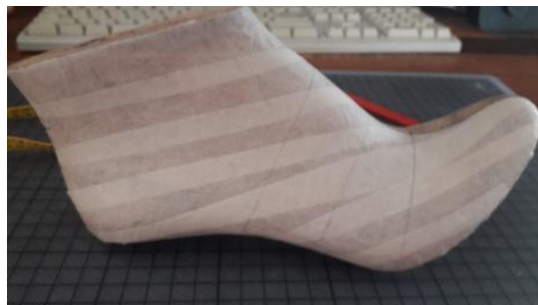
Εικόνα 3.3 Καλαπόδι με την εξωτερική του πλευρά ντυμένη με χαρτοταινία[21]
