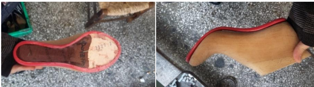
Εικόνα 6.17 Τοποθέτηση πάτου στο καλαπόδι για μοντάρισμα[33]
