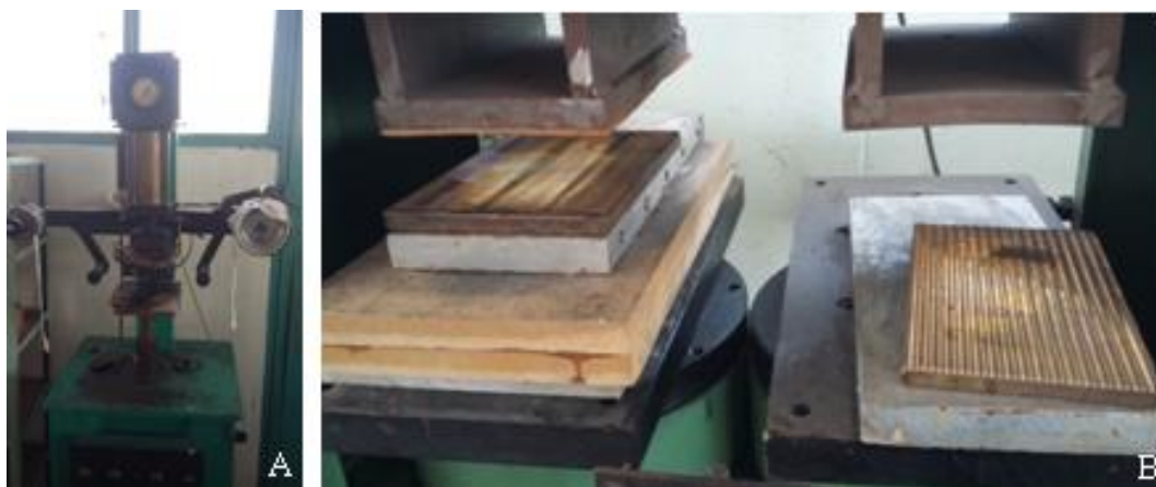
Εικόνα 4.25 Θερμοτυπική μηχανή για τοποθέτηση μεγέθους με χρήση κορδέλας (Α), για δημιουργία ανάγλυφου σχεδίου (Β)
