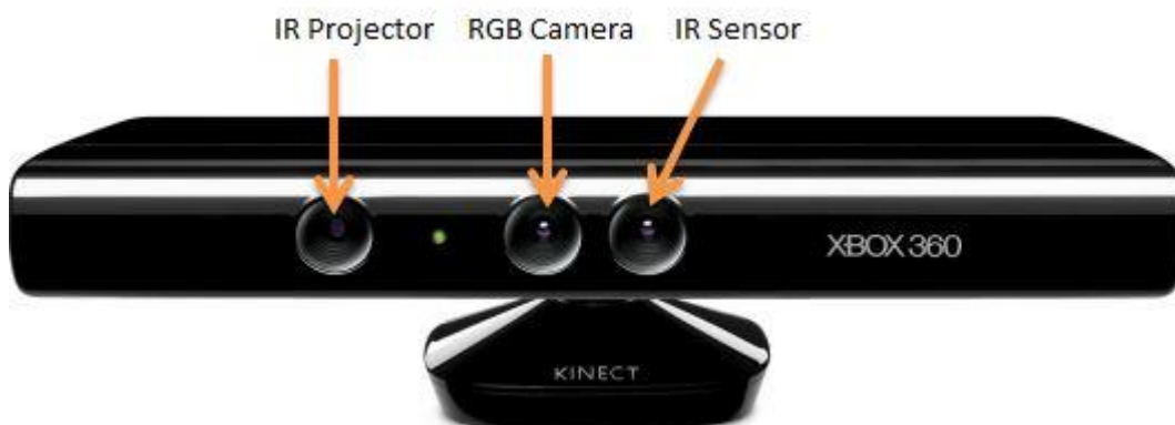
Εικόνα 1. Δομή συσκευής Kinect
