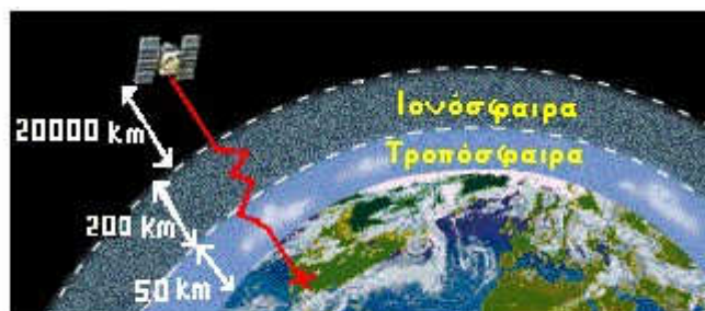
Σχήμα 8. Η διαδρομή του σήματος του δορυφόρου μέσω της ατμόσφαιρας
