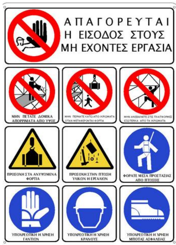
Εικόνα 11 Πινακίδα με μέτρα ασφαλείας που πρέπει να τηρούνται μέσα στο εργοτάξιο 13
