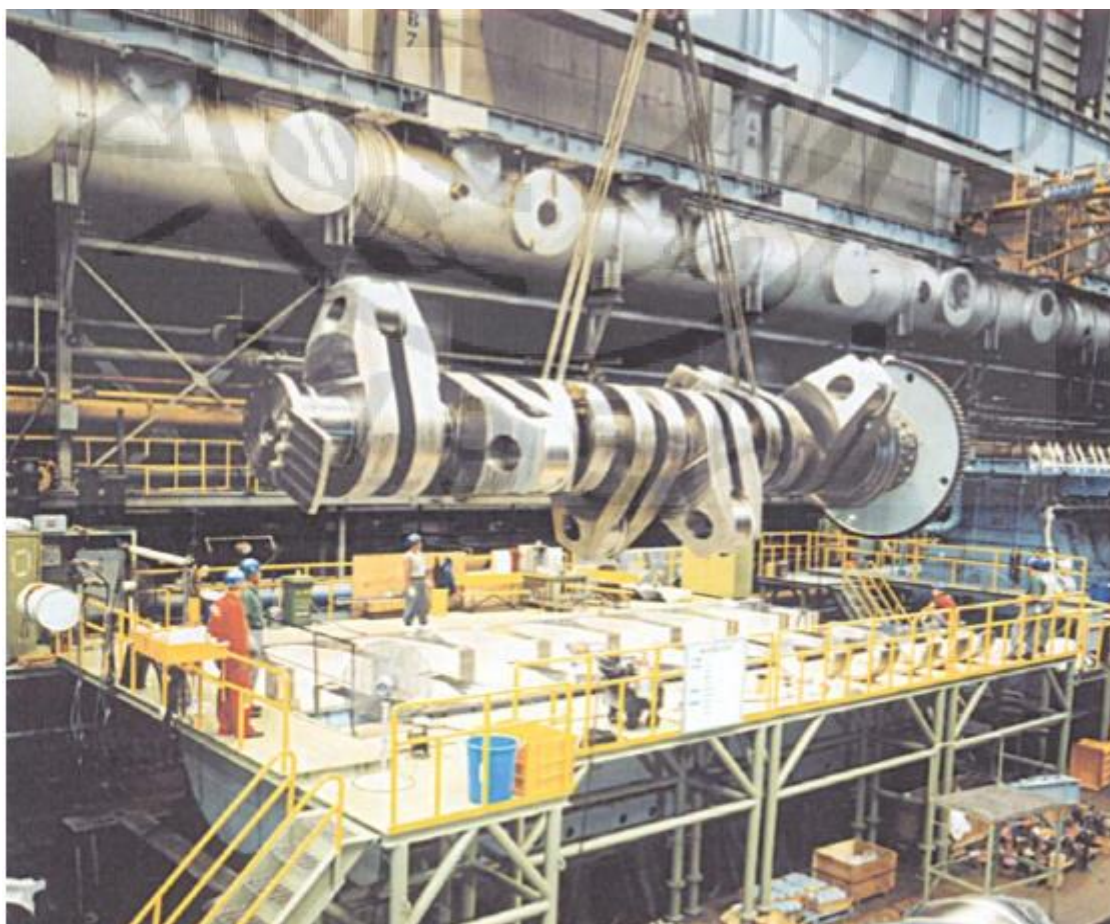
Εικόνα 4.12: Στροφαλοφόρος άξονας μεγάλης αργόστροφης δίχρονης πετρελαιομηχανής, στο στάδιο τοποθέτησης του στην βάση της μηχανής. [8]
