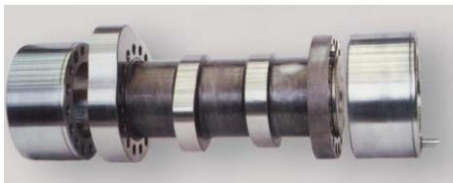
Εικόνα 4.13: Εκκεντροφόρος άξονας τετράχρονης μεσόστροφης πετρελαιομηχανής ενός κυλίνδρου, με το αριστερό έκκεντρο της αντλίας καυσίμου και τα δεξιά έκκεντρα των βαλβίδων. [8]
