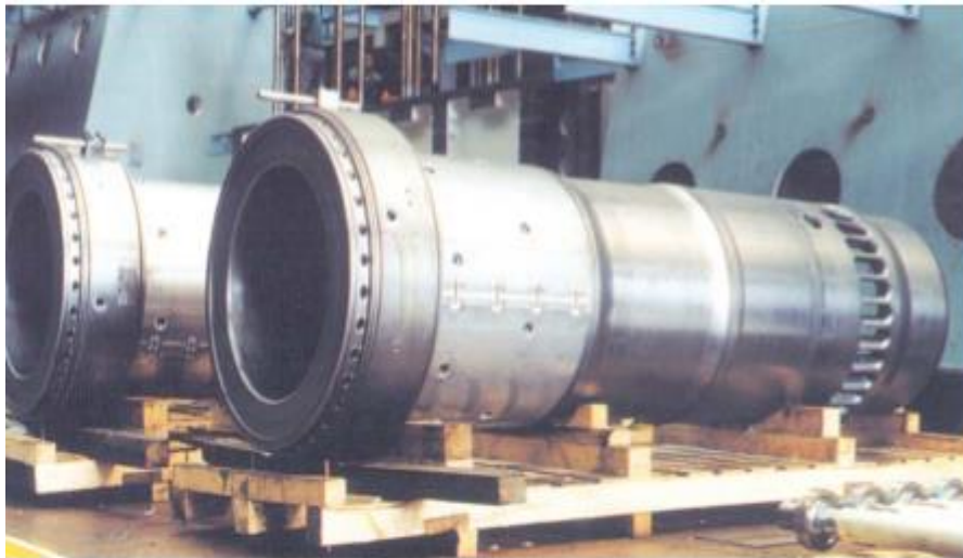
Εικόνα 4.5: Χιτώνια δίχρονης πετρελαιομηχανής, με εσωτερική διάμετρο 84 cm και διαδρομή εμβόλου 315 cm. [8]
