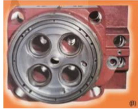
Εικόνα 4.7: α) Βαλβίδα επαπτόμενη πάνω στην αφαιρούμενη έδρα της σε τομή. β) Θέση στην κεφαλή στην οποία τοποθετούνται οι έδρες των τεσσάρων βαλβίδων. [8]
