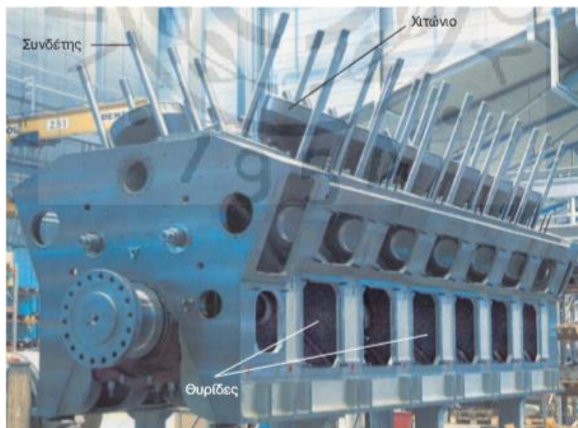
Εικόνα 4.3: Σκελετός δωδεκακύλινδρης μεσόστροφης πετρελαιομηχανής, από χυτοσίδηρο, τύπου (V). [8]
