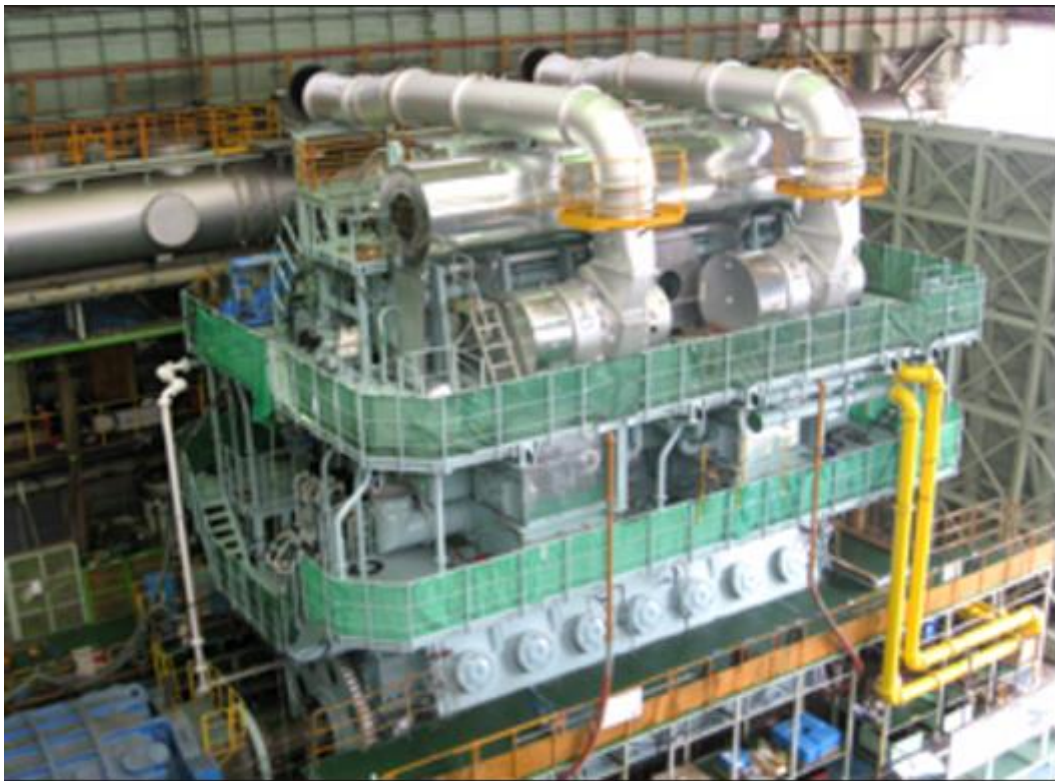
Εικόνα 4.21: Αργόστροφη δίχρονη πετρελαιομηχανή. [11]
