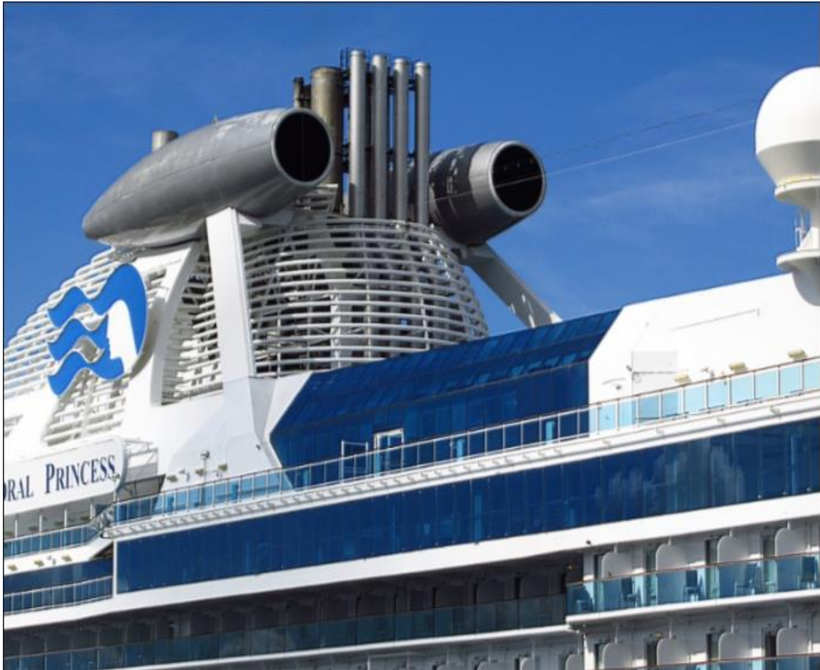
Εικόνα 3.13: Απεικόνιση εφαρμογής αεριοστροβίλου σε κρουαζιερόπλοιο. [14]
