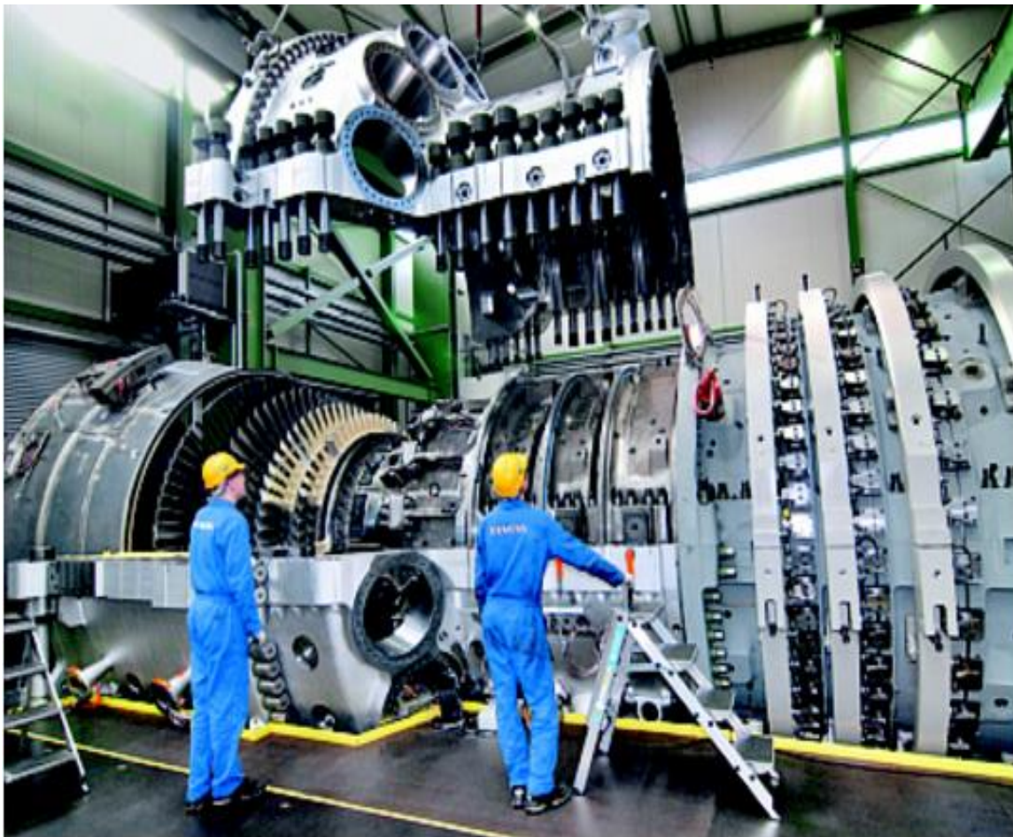
Εικόνα 3.12: Απεικόνιση του μεγαλύτερου σε ισχύ αεριοστρόβιλου με προορισμό τα πλοία (και άλλες εφαρμογές ξηράς). [16]
