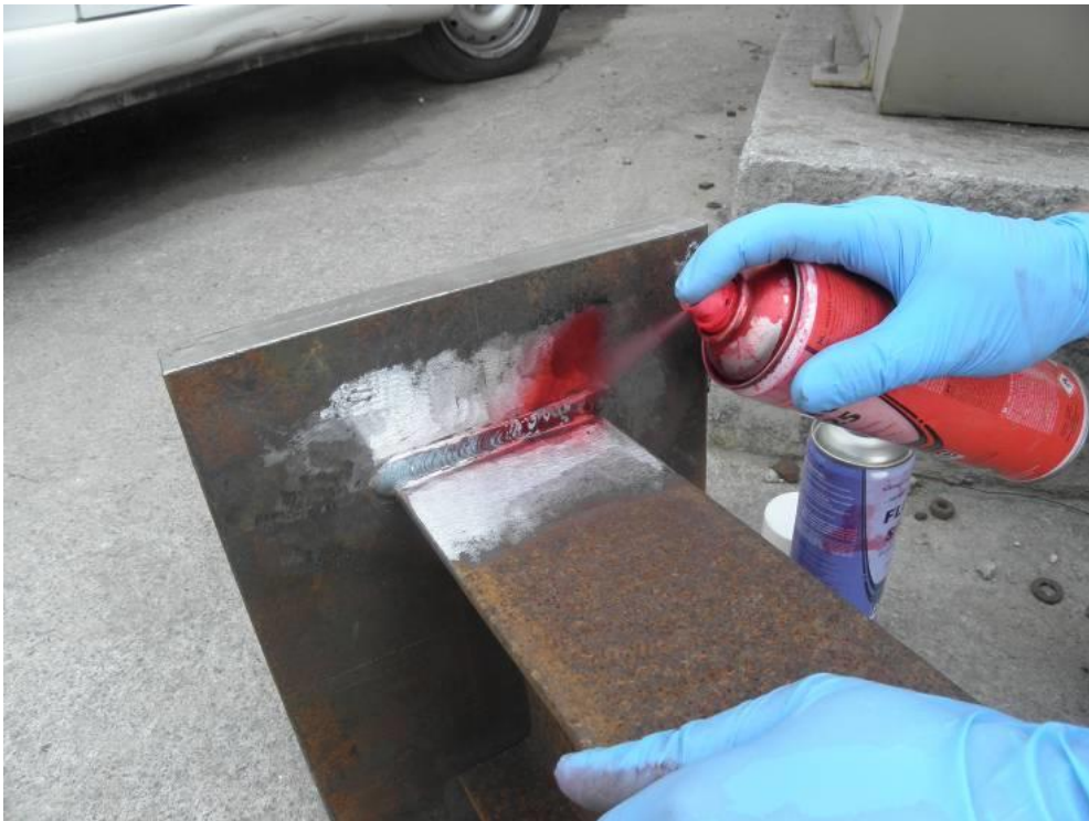
Σχήμα 5.13 Εφαρμογή διάλυτο-αφαιρούμενου διεισδυτή.
