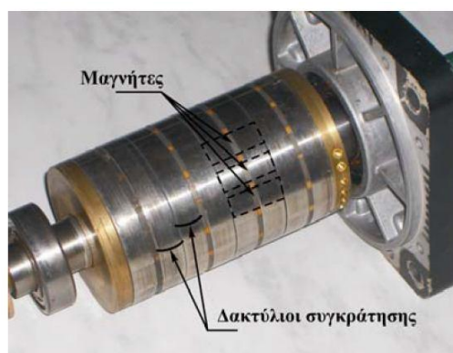
Εικόνα 8.3 Σύγχρονες μηχανές μόνιμου μαγνήτη(ΣΜΜΜ) (“Σερβοκινητήρια Συστήματα”, Χρήστος Μαδεμλής)
