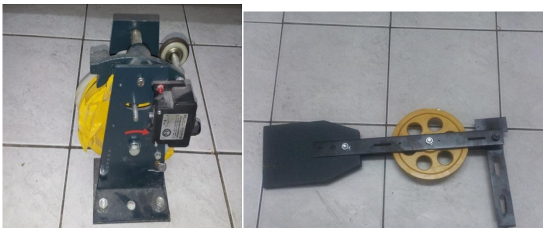
Εικόνα 7.1 Αριστερά: Πάνω μέρος περιοριστήρα ταχύτητα, (Πηγή: Γκολώνης Χρ.) Δεξιά: Κάτω μέρος περιοριστήρα ταχύτητας.
