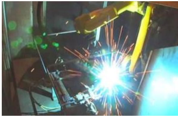
ΕΙΚΟΝΑ 9: συγκόλληση τόξου μέσω ρομποτικού βραχίονα
