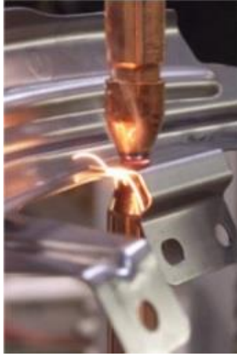
ΕΙΚΟΝΑ 8: ηλεκτροσυγκόλληση αντίστασης
