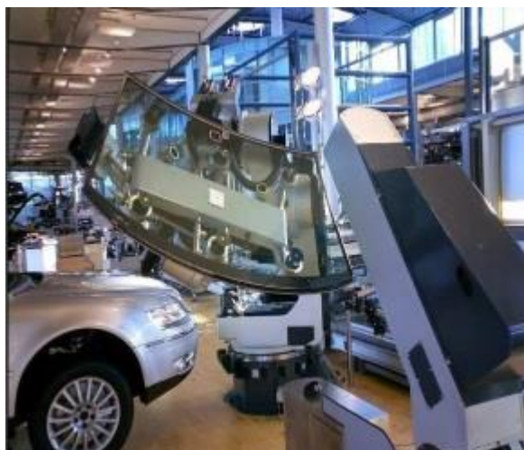
ΕΙΚΟΝΑ 12: σήμερα οι ανεμοθώρακες τοποθετούνται από ρομπότ
