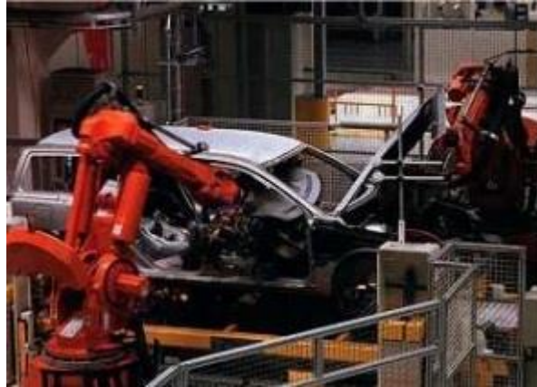
ΕΙΚΟΝΑ 10: συναρμολόγηση εσωτερικού χώρου από ρομποτικούς βραχίονες
