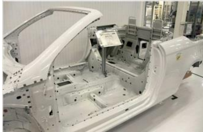
ΕΙΚΟΝΑ 7: δωμάτιο με έντονη φωτεινότητα για την επιθεώρηση του αμαξώματος
