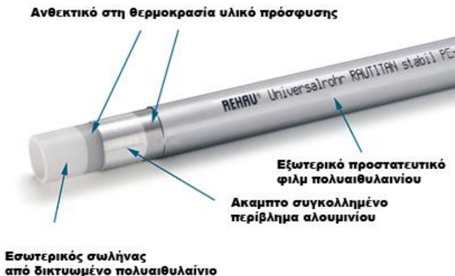
Τομή πολυστρωματικής σωλήνας
