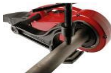
β) Δημιουργία σπειρώματος χαλυβδοσωλήνας με ηλεκτρικό βιδολόγο
