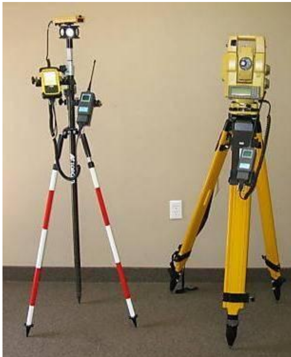
Topcon GTS-series & όργανα χρήσης GPS-Πυξίδα ένδειξης μαγνητικού Βορρά
