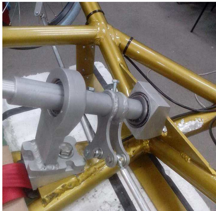
Εικόνα 4-13: Τρίγωνο σε κολώνα υπό κλίση, στο σύστημα διεύθυνσης του Trireme I (μονοθέσιο ομάδας «Ποσειδών» στο διαγωνισμό Shell Eco Marathon Europe 2014).
