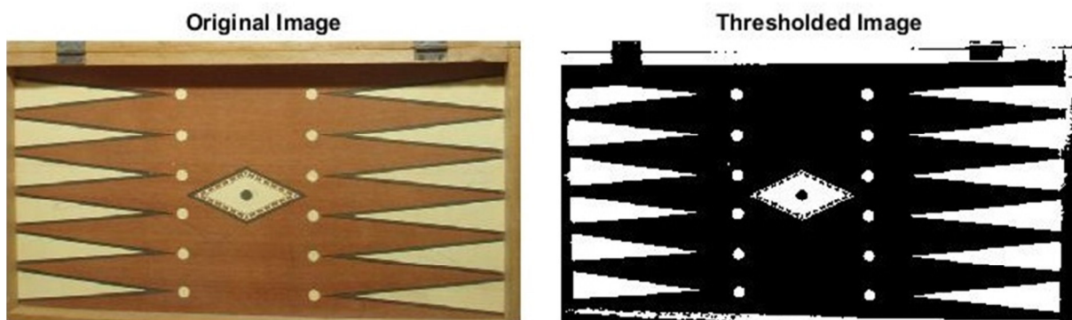
Εικόνα 10: Κατάτμηση εικόνας με τη μέθοδο του Ότσου (Otsu Thresholding)
