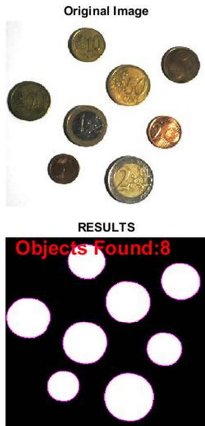
Εικόνα 61: Καταμέτρηση αντικειμένων Τεστ 1 ο
