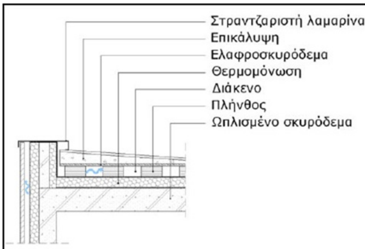
Σχήμα 3.29: Τομή σε αεριζόμενο δώμα (Πηγή: http://www.scribd.com/doc/49713800/ )
