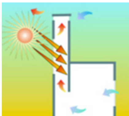
Σχήμα 3.26: Ηλιακή καμινάδα (Πηγή: http://www.cres.gr/energy_saving/Ktiria )
