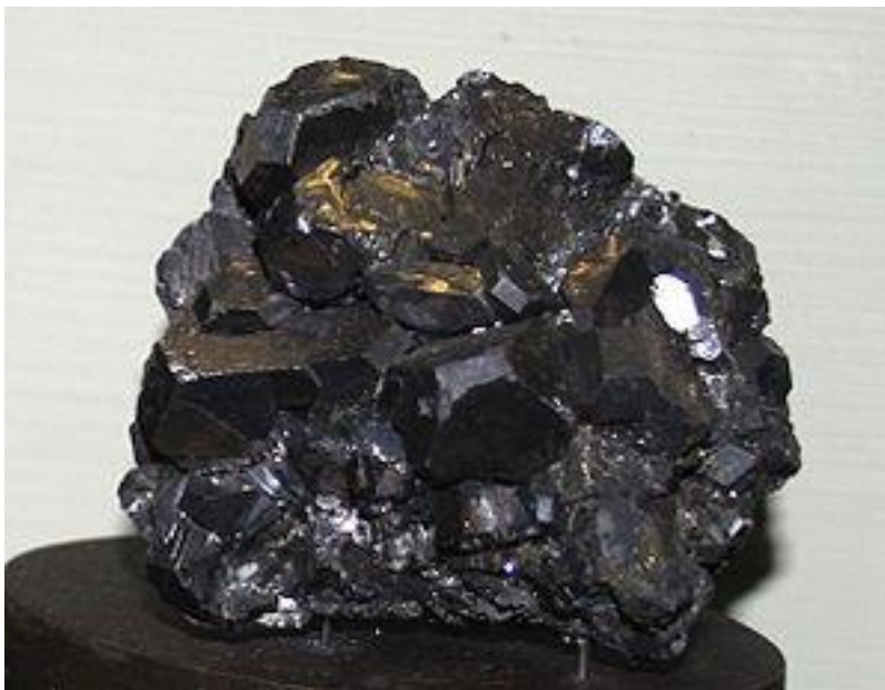
Εικ.8. - Γαληνίτης (αγγλ. Galena) είναι ορυκτό και το κυριότερο μέταλλευμα του μολύβδου. Έχει χημικό τύπο PbS (θειούχος μολύβδος)
