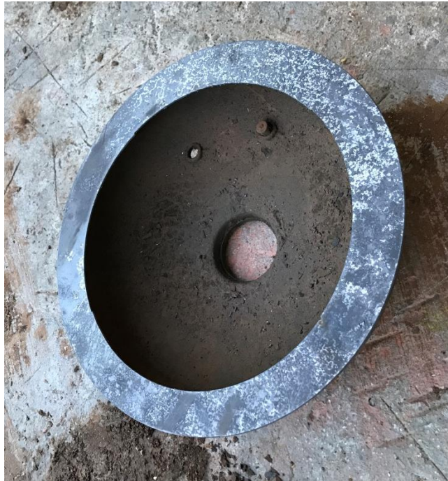
Εικ.4. –Καπάκι καμινιού με ειδικά διαμορφωμένο δαχτυλίδι για τη στήριξη του θερμομονωτικού υλικού
