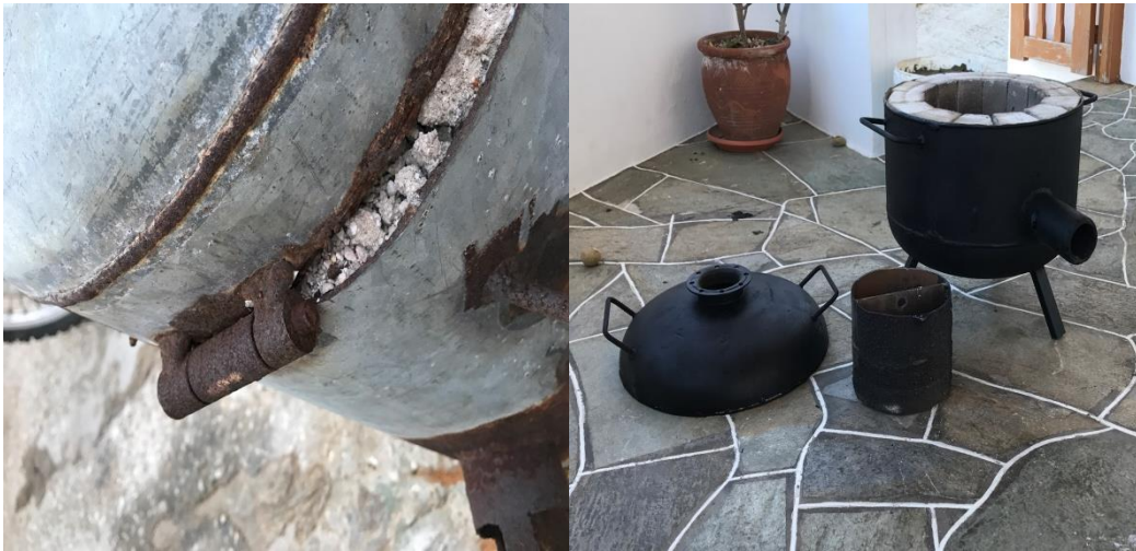
Εικ.14. – Παλιό και νέο καμίνι – τρόπος ανοίγματος καπακιού
