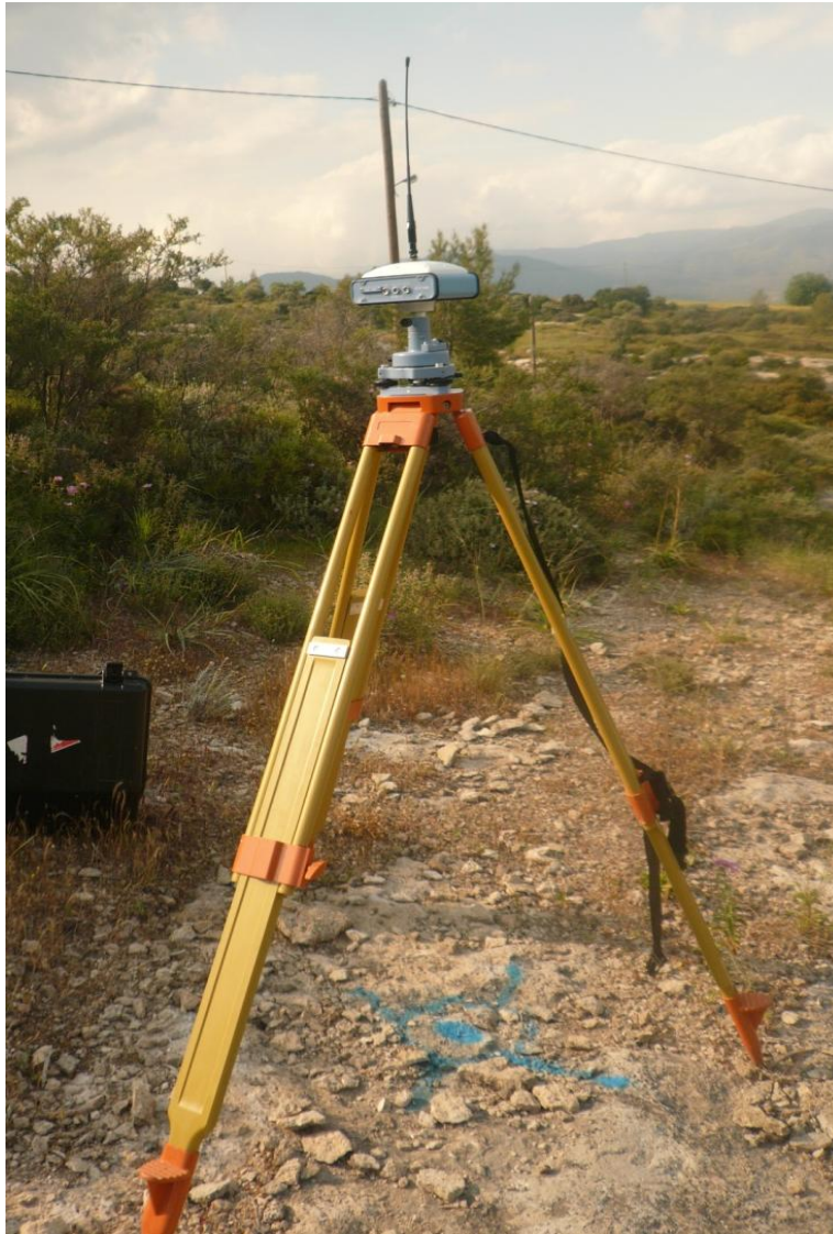
Εικόνα 17 GPS S86 κατά τη διαδικασία εξάρτησης των σημείων απ'το τριγωνομετρικό.
