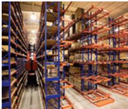
Εικόνα 18 - Ράφια παλέτας πολύ στενών διαδρόμων (πηγή: rackingsafetyaudits.com.au)
