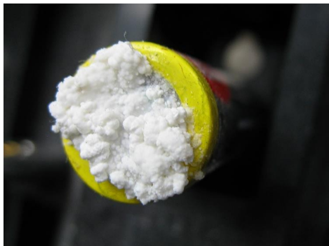
Σχήμα 3.10 Διαρροή μπαταρίας Πηγή από: https://en.wikipedia.org/wiki/Battery_(electricity)
