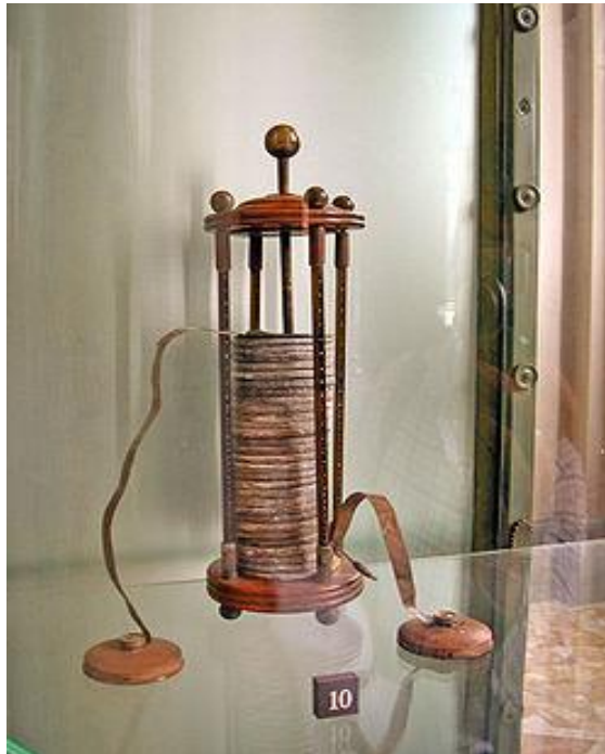
Σχήμα.3.2 Voltaic pile του Alessandro Volta Πηγή από: https://en.wikipedia.org/wiki/Voltaic_pile
