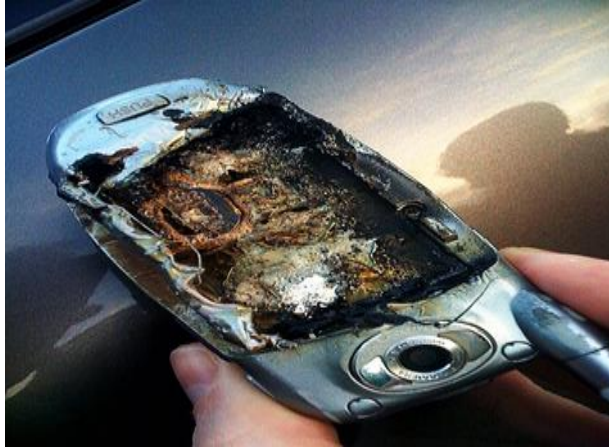
Σχήμα 3.9 Έκρηξη μπαταρίας Πηγή από: https://en.wikipedia.org/wiki/Battery_(electricity)
