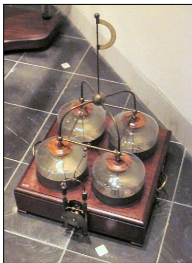
Εικόνα 1.2: Συσκευή που αποθηκεύει στατικό ηλεκτρισμό γνωστή ως «βάζο του Leyden»
