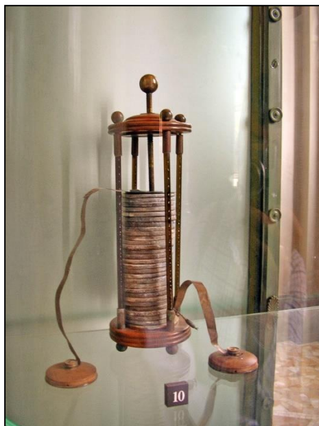
Εικόνα 1.4: Η πρώτη χημική μπαταρία γνωστή ως “βολταϊκή στήλη”
