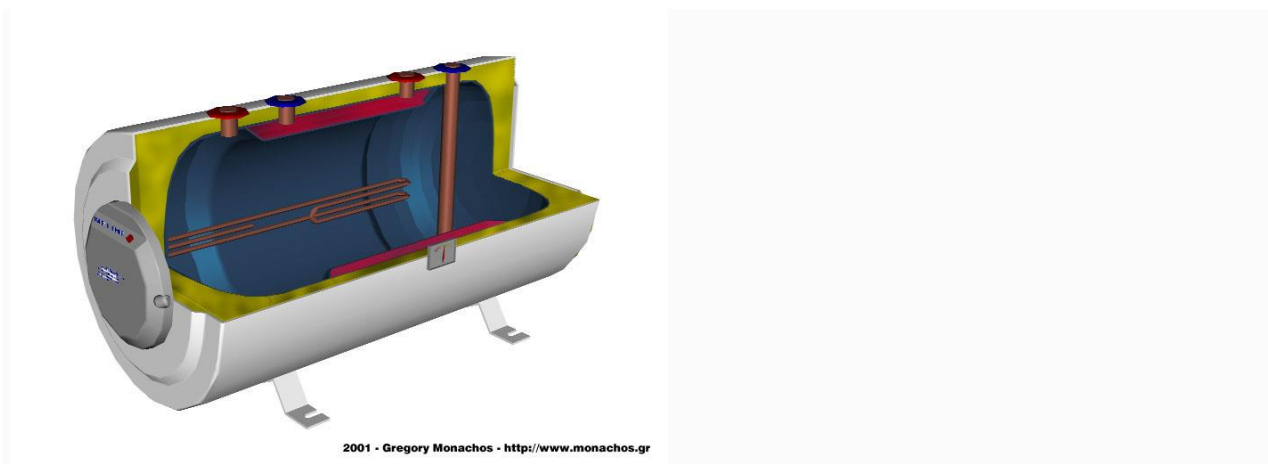
Εικόνα 2.4 Μπόιλερ ζεστού νερού χρήσης
