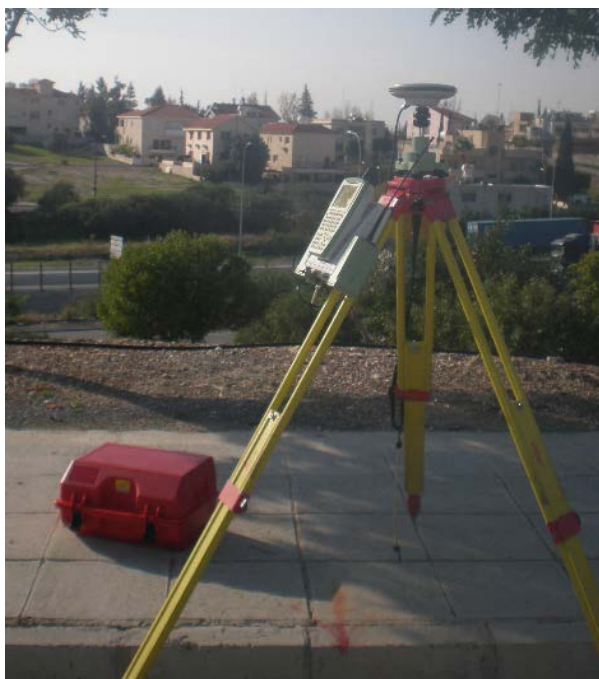
Εικόνα 25 Σύγχρονος γεωδαιτικός σταθμός
