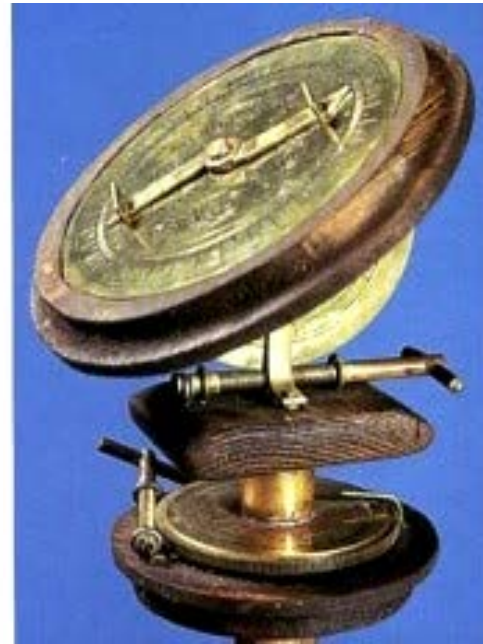
Εικόνα 20 Η γεωδαιτική δίοπτρα του Ήρωνα (1ος αι. μ.Χ.) είναι ένα φορητό εργαλείο που επιτρέπει γεωδαιτικές μετρήσεις επί της επιφάνειας της Γης
