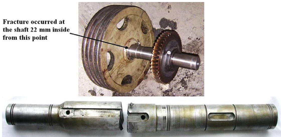
Εικόνα 5.4 Απεικόνιση αστοχίας ατράκτου 22 mm στη περιοχή της εγκοπής.
