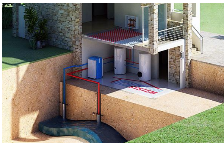
Εικόνα 65: Σύστημα Γεωθερμίας Ανοιχτού Κυκλώματος ( www.infloorsystem.gr )
