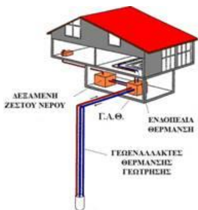
Εικόνα 67: Κάθετο Σύστημα Γεωθερμίας Κλειστού Κύκλου (www.cie.org.cy)
