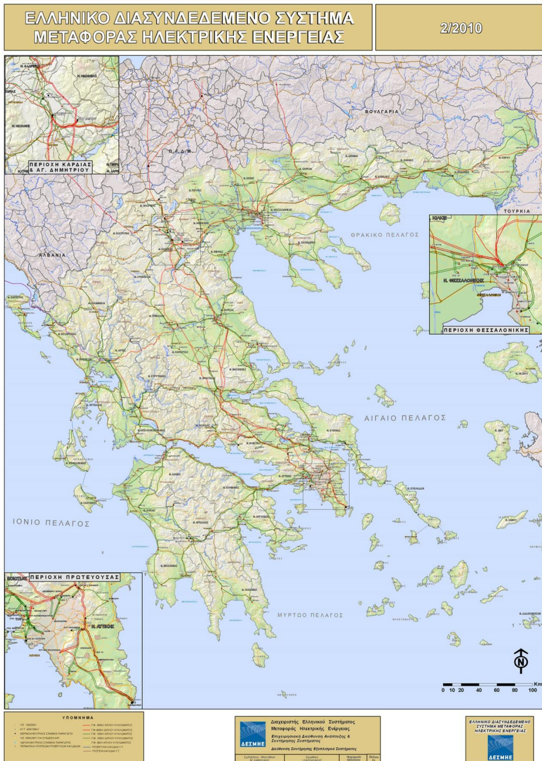
Εικόνα 3.1 Το Ελληνικό Διασυνδεδεμένο Σύστημα Μεταφοράς Ηλεκτρικής Ενέργειας
