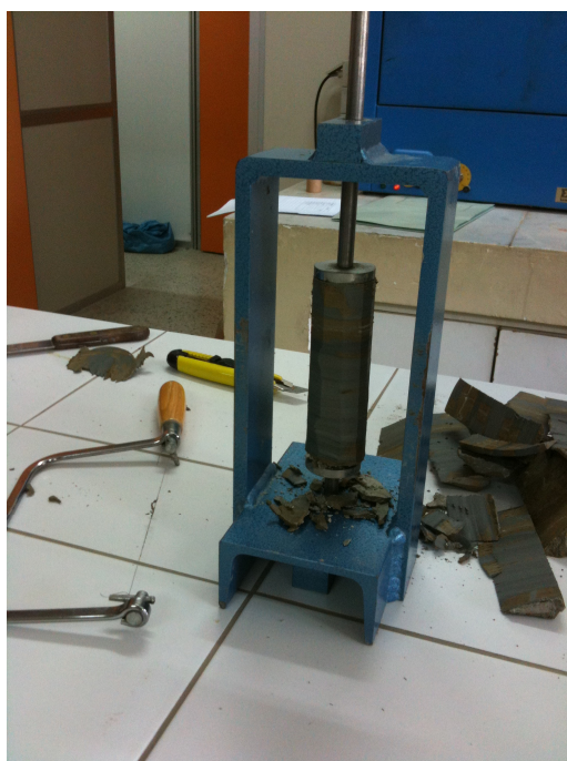
Τόρνος (συσσκευή διαμόρφωσης κυλινδρικού δοκιμίου)
