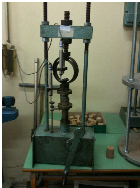
Μηχανή Θλίψης με κυλινδρικό δοκίμιο κατά την διάρκεια εκτέλεσης της δοκιμής.
