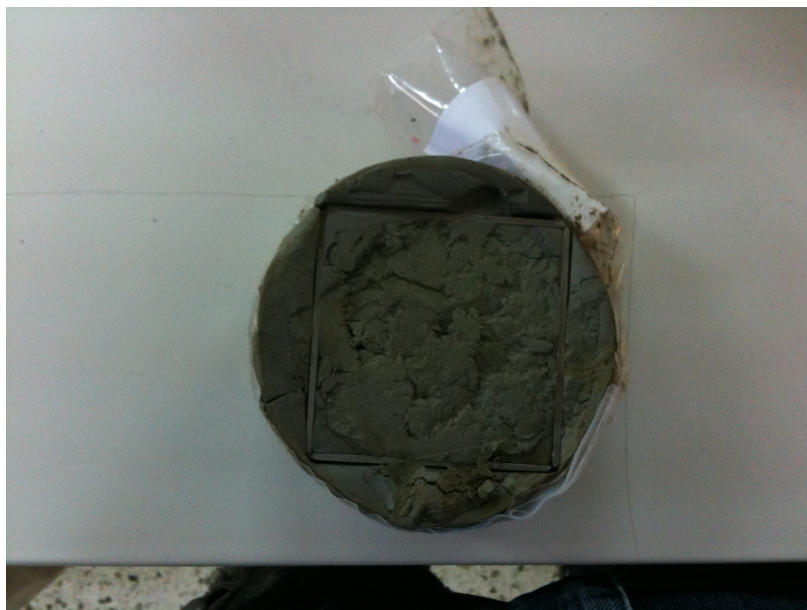
Διαμόρφωση δοκιμίου για το πείραμα της διάτμησης.
