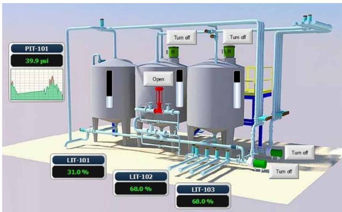
Απεικόνιση ελέγχου δεξαμενών μέσω συστημάτων SCADA
