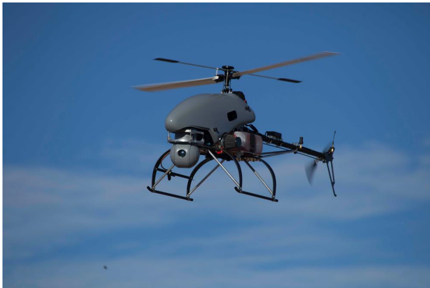
Εικόνα 3: Παράδειγμα Μη Επανδρωμένου Αεροσκάφους Περιστρεφόμενης Πτέρυγας [60]
