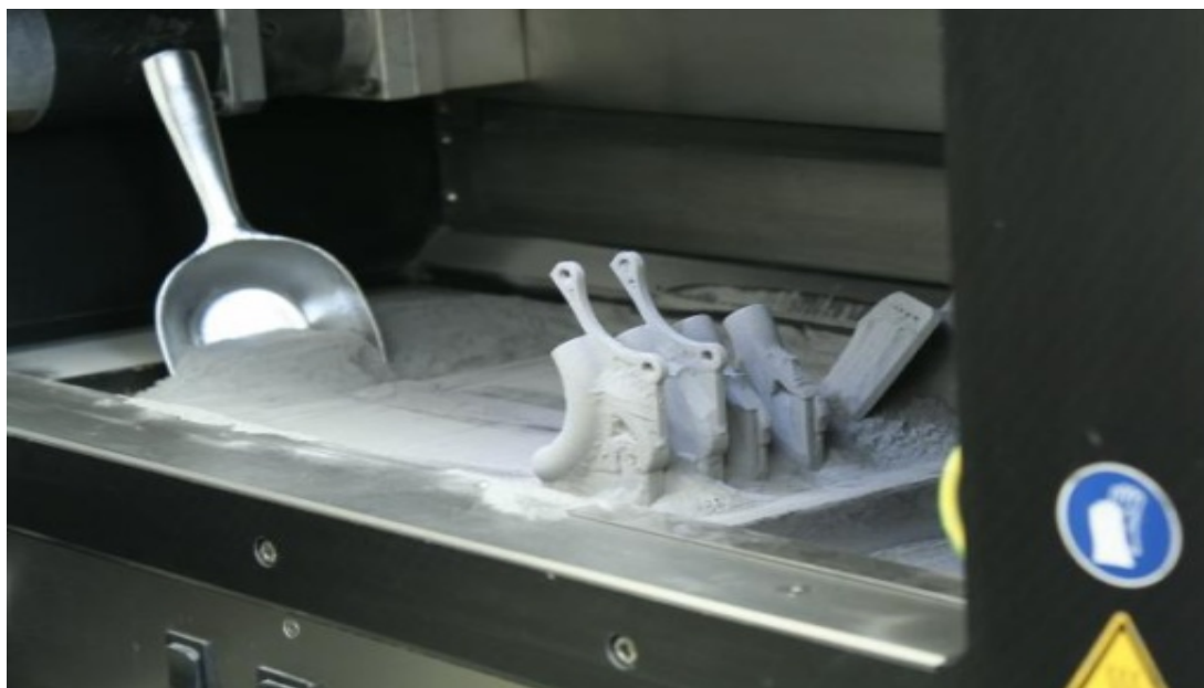
Εικόνα 4.15. Εξαρτήματα ποδηλάτου από τιτάνιο ακριβώς μετά την εκτύπωση τους και πριν το στάδιο του καθαρισμού τους
