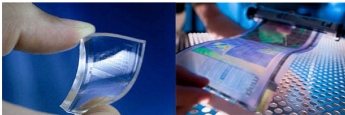
Εικόνα 4.21. Εκτυπωμένες μεμβράνες από γραφένιο και νανοσωματίδια που φτάνουν σε πάχος 50-150 μm, ιδιαίτερα ευέλικτες, που είναι εξαιρετικά αγώγιμες και εμφανίζουν περίπου 2 - 3ohm αντίσταση σε μια περιοχή 2".
