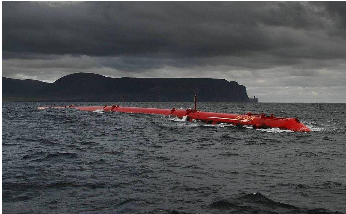
Εικόνα 2.2: Μετατροπέας ενέργειας κυμάτων Pelamis
